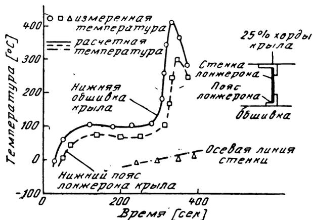
Фиг. 10. Сравнение расчетной и измеренной температуры конструкции; полет на высоте 96 км
