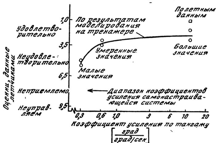
Фиг. 5. Влияние изменения коэффициента усиления демпфирования на управляемость при входе с высоты 110 км. Система управления по скорости
