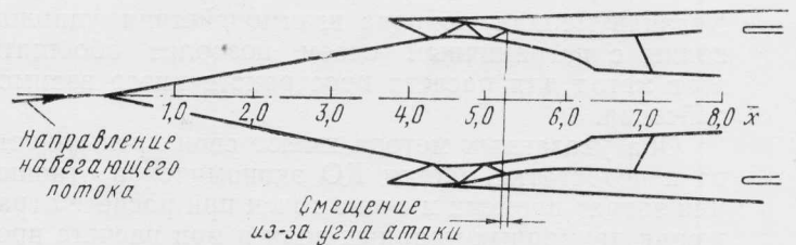
Рис. 2. Определение положения ударных волн методом характеристик ( M=2,5 ; \alpha=3^\circ ; x —расстояние вдоль оси воздухозаборника, отнесенное к радиусу обечайки)
