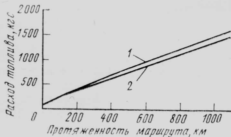
1—минимальные эксплуатационные расходы; 2—минимальный расход топлива Рис. 6. Зависимость рейсового расхода топлива от протяженности маршрута самолета АТР (максимальное число пассажиров, условия МСА, безветрие)
