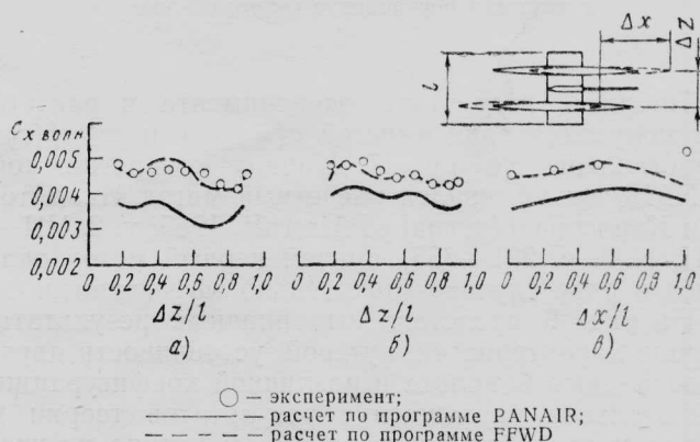
Рис. 5. Зависимость коэффициента волнового сопротивления от относительного расположения фюзеляжей ( M=2,7 ; а — \Delta x/l=0 ; б — \Delta x/l=0,5 ; в — \Delta y/l=0,25 )
