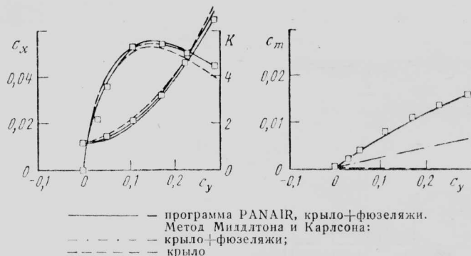
Рис. 7. Зависимости c_x = f(c_y) и m_z = f(c_y) . (Расчет и эксперимент, M = 2,7 , \Delta x/l = 0 , \Delta z/l = 0,25 )
