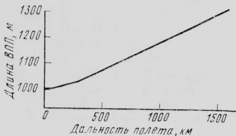
Рис. 7. Зависимость потребной длины ВПП от дальности полета самолета АТР (максимальное число пассажиров, условия МСА, H=0 , резервы топлива на ожидание на высоте 3050 м в течение 45 мин и полет на запасной аэродром на расстояние ~280 км)
