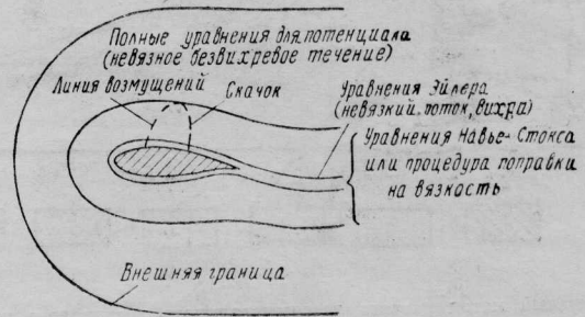
Рис. 13. Зональный метод для расчета обтекания крыла
