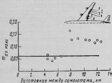
○ — самолет В-747 в стандартной посадочной конфигурации; □ — то же, плюс отклонение секций 1 и 2 интерцепторов на 41°
