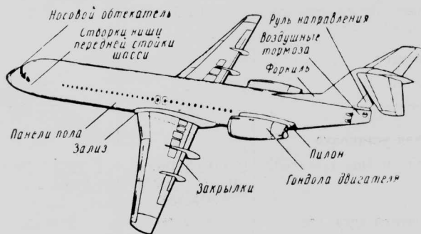
Рис. 14. Использование композиционных материалов в конструкции планера самолета Фоккер 100
