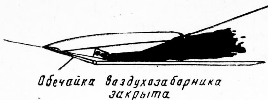
Рис. 7. Использование тракта встроенного ракетного двигателя для расширения потока
