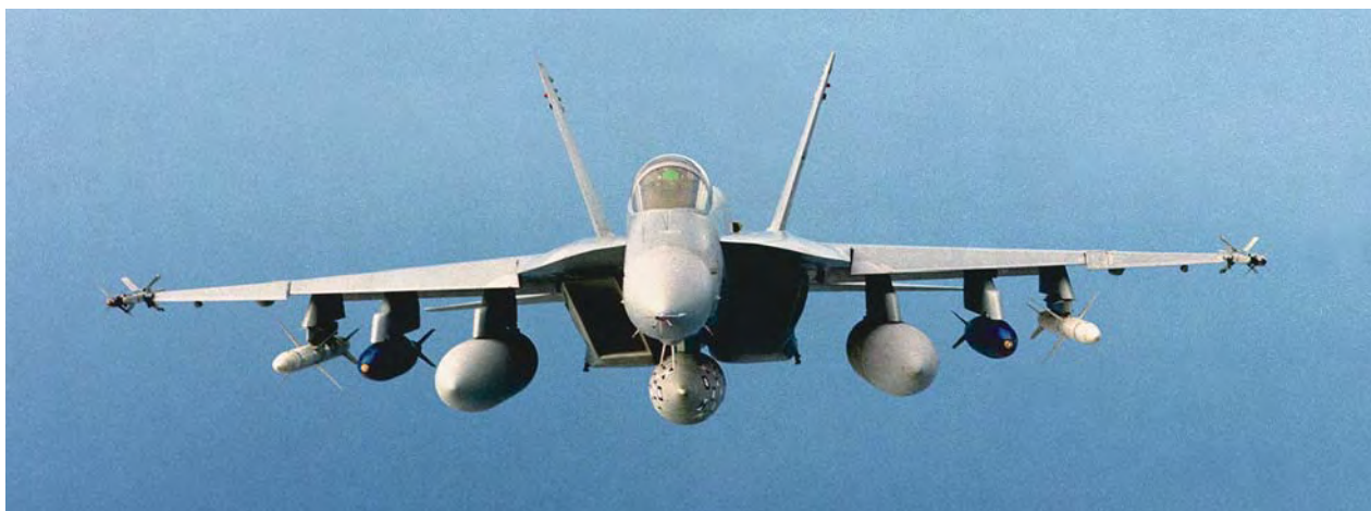
Хорошо видно расположение узлов подвески вооружения
