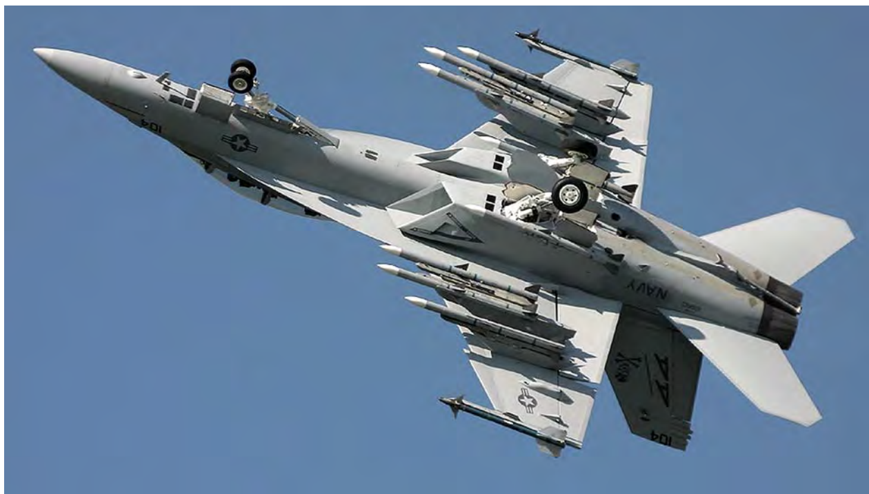
Самолет F/A-18F с ракетами AIM-120 на спаренных адаптерах
