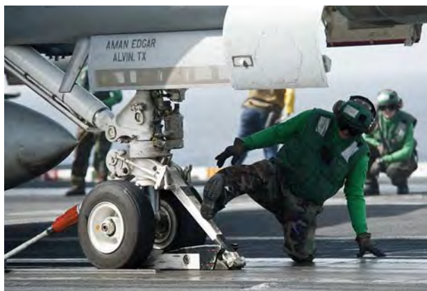
Установка поводка носовой стойки шасси на башмак катапульты
