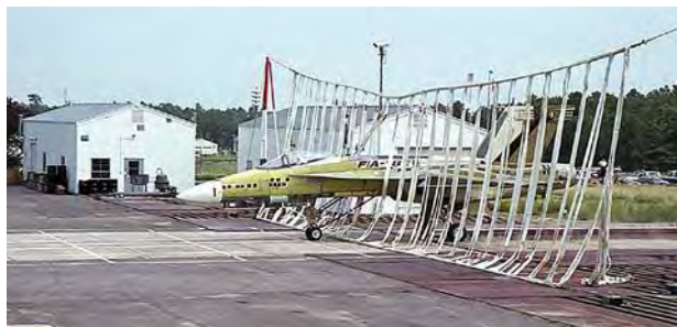
Планер ST50 во время исследований аварийной посадки с помощью заградительного барьера
