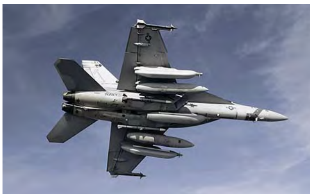
Опытный самолет E1 с подвесным баком, агрегатами заправки и УР воздух — воздух
