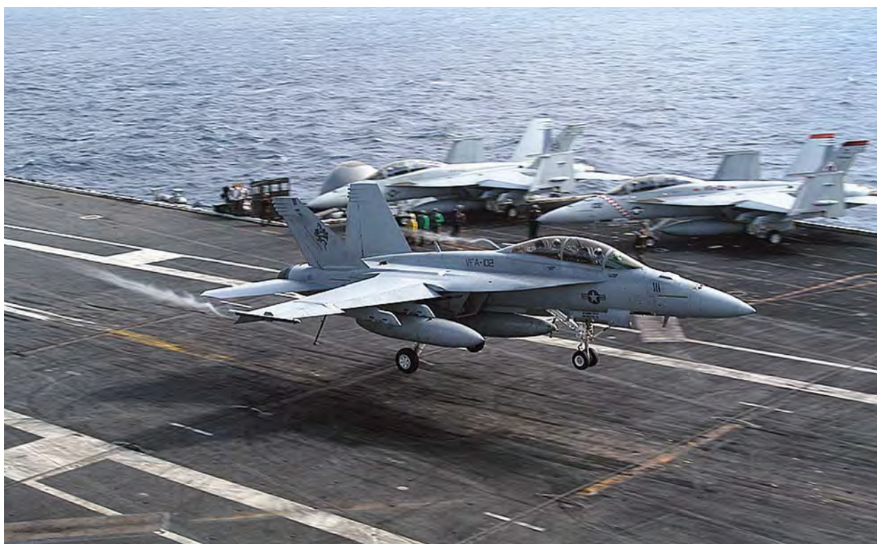
Посадка самолета F/A-18E с тремя подвесными баками на авианосец «Джон С. Стеннис»
