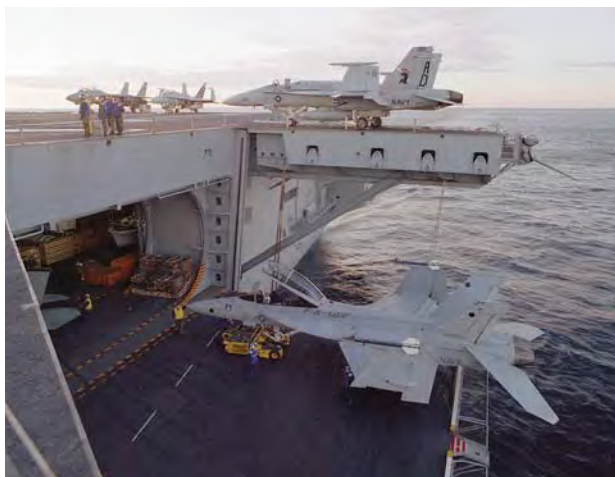
Опытный самолет F1 (на подъемнике) во время испытаний на совместимость с авианосцем
