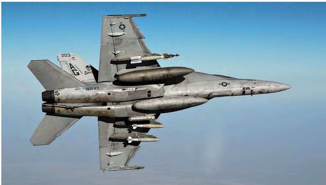
Самолет F/A-18F с вариантом вооружения для действий по наземным целям
