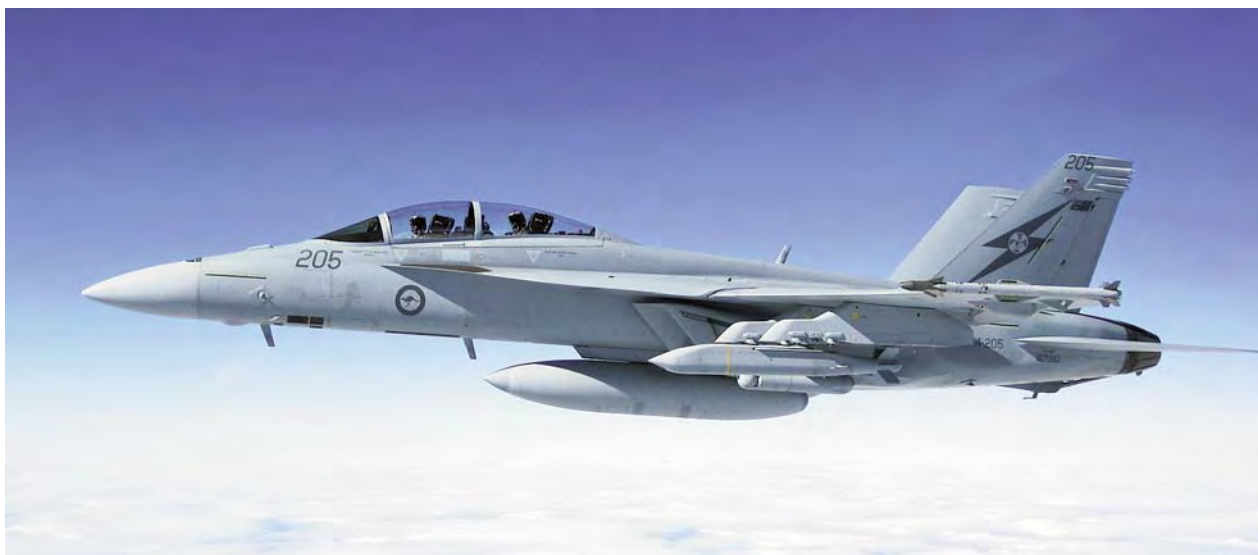
Самолет F/A-18F с ракетами AGM-154 JSOW под крылом и контейнером AAQ-14 LANTRIN на пилоне под левым воздухозаборником
