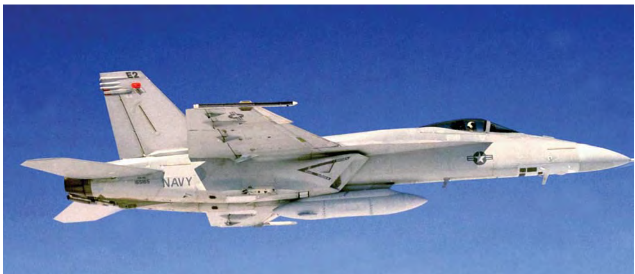
Второй опытный экземпляр E2 с контейнером SHARP под фюзеляжем
