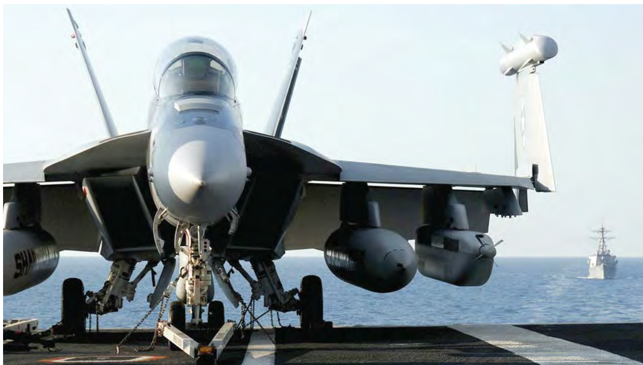
Контейнер ALQ-99 (под крылом) и контейнер с антеннами комплекса AN/ALQ-218(V2) (на конце крыла)
