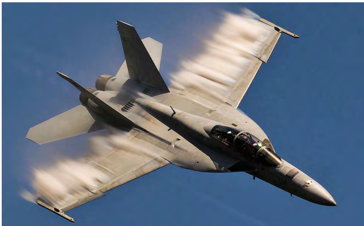
Вихри на крыле самолета F/A-18F, хорошо заметные во влажном воздухе
