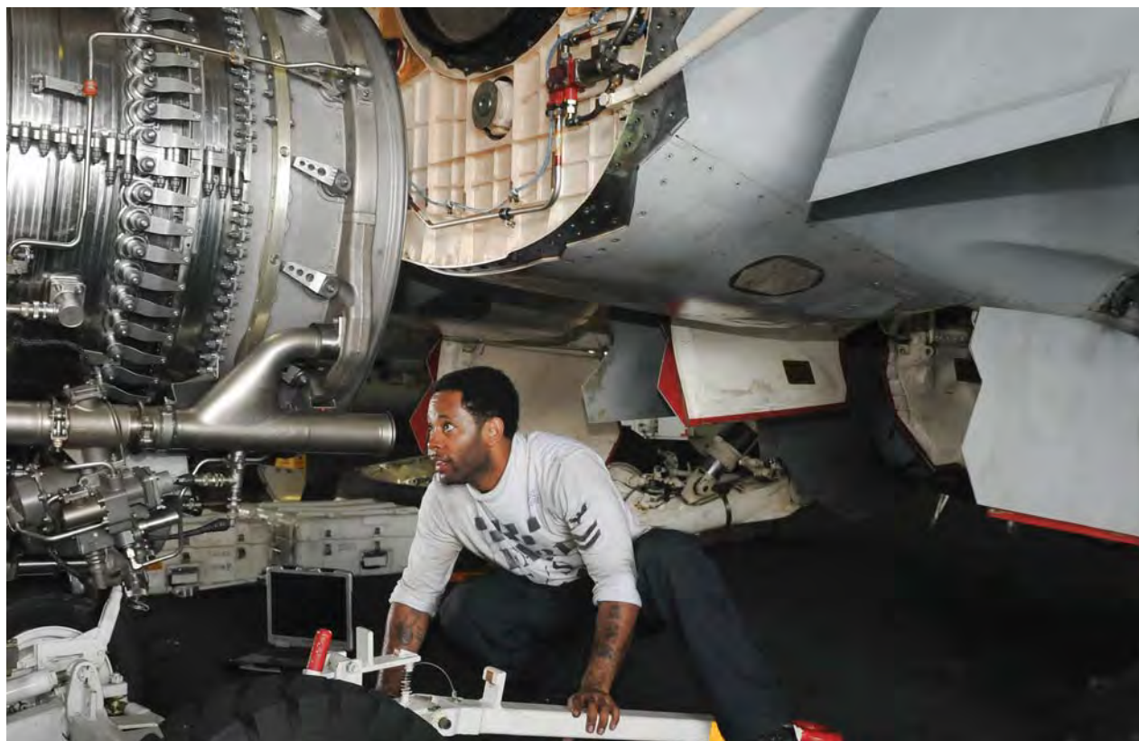
Замена двигателя. Хорошо видны силовой шпангоут и зигзагообразные стыки обшивки
