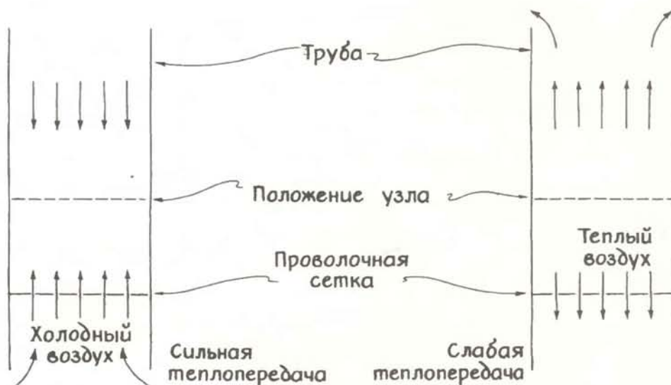
Движения воздуха в трубе осциллятора Рийке.
