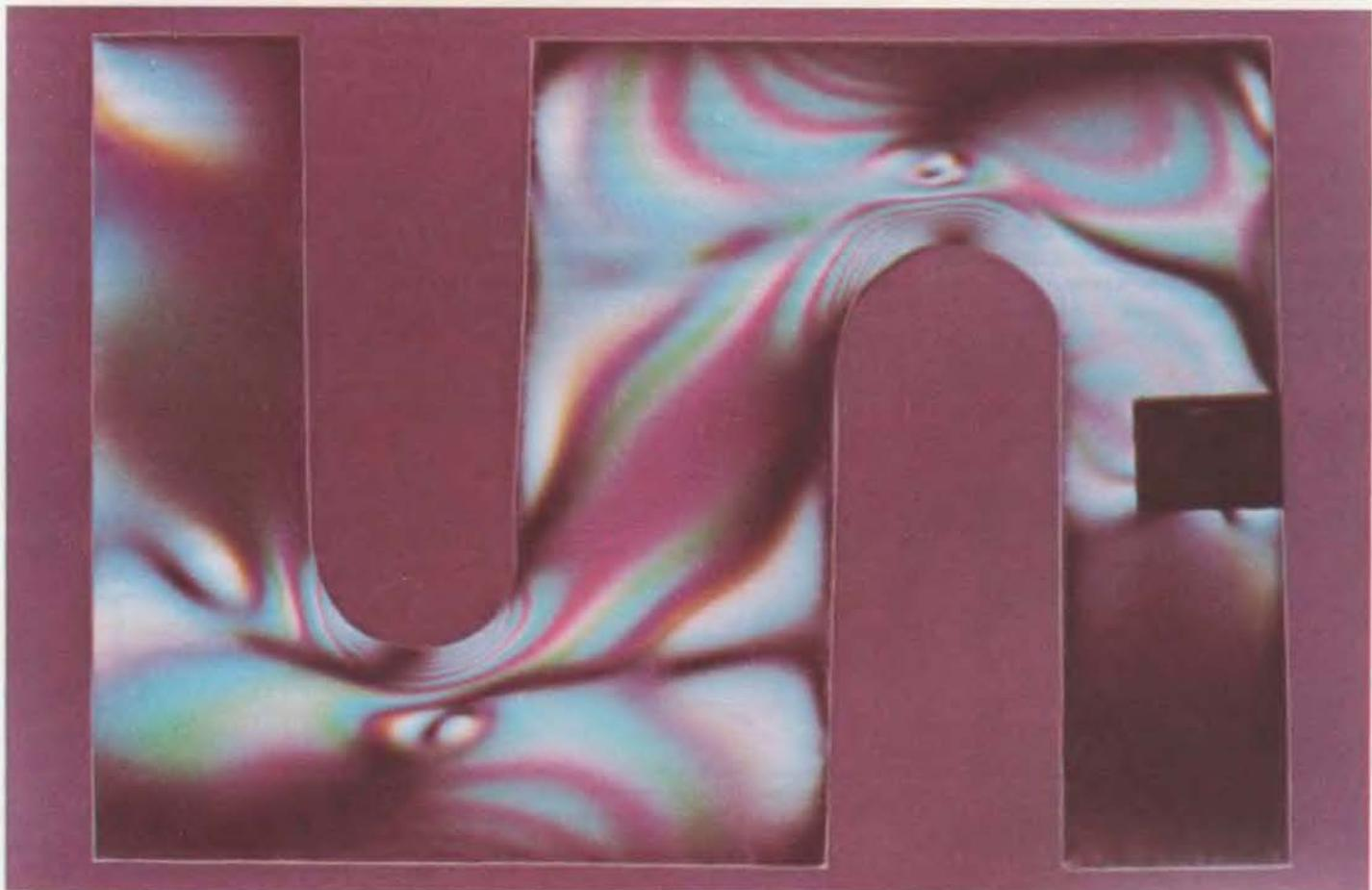
*Две пластмассовые модели Сьюферта, подвергнутые действию сил сжатия.*
