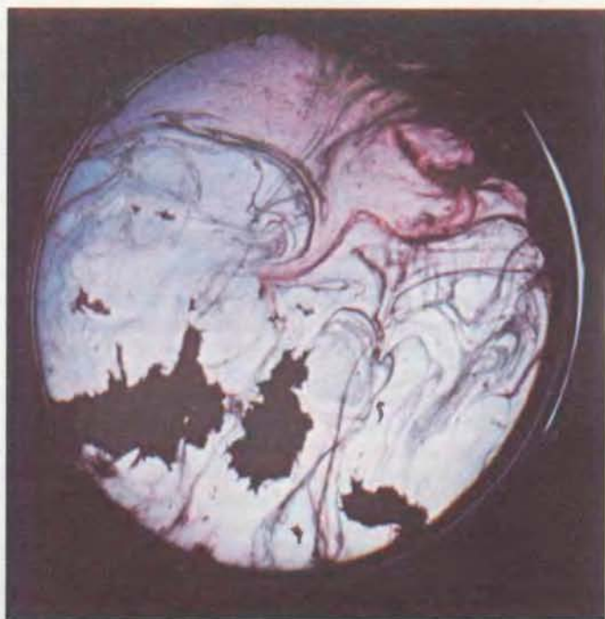
Воздействие нашатырного спирта на керосин и олеиновую кислоту
