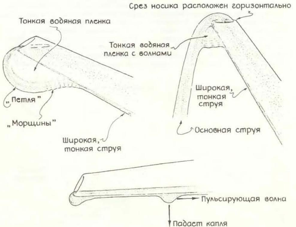
Разные формы течения при наличии чайникового эффекта
