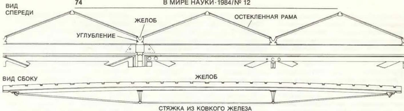
**ДЕРЕВЯННЫЕ ЖЕЛОБА**, по которым вода стекала с крыши в трубчатые колонны и затем в подземные трубы, одновременно выполняли роль балок. Стягивающие стержни из ковкого железа (*внизу*), слегка изгибаемая желоба наружу, придавали им жесткость. Этот прием был шагом вперед на пути к используемому в наше время методу предварительного на-
