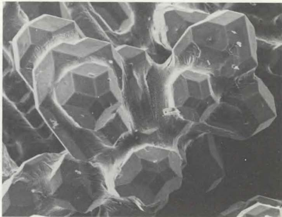
КВАЗИКРИСТАЛЛ, полученный Ф. Гейлом из Reynolds Metals Company, имеет граненые дендриты (ветви). Симметрия пятого порядка в расположении граней (пять граней сходятся в одной вершине) указывает на такую же симметрию микроструктуры квазикристалла. Длинная диагональ самой большой грани, видной на этом снимке, равна примерно 100 мкм.
