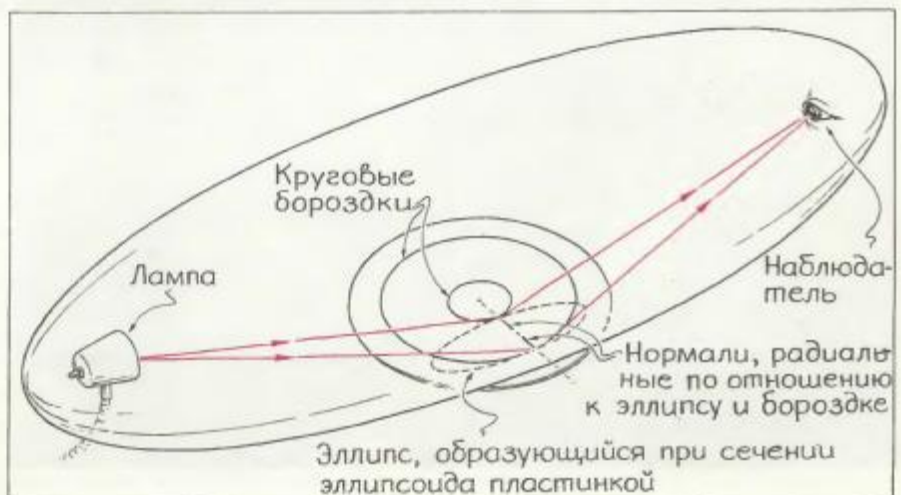
Свет отражается от внутренней поверхности эллипсоида
