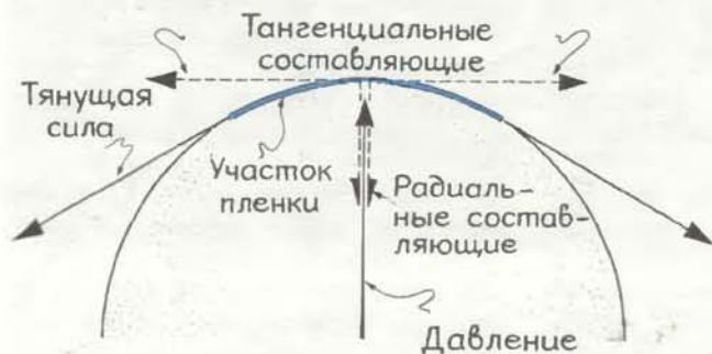
Силы, действующие на участок поверхности в маленьком и большом мыльных пузырях
