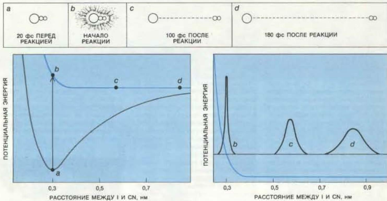
**ФЕМТОСЕКУНДНАЯ ДИНАМИКА** молекулы цианида иода лучше всего описывается с помощью кривых потенциальной энергии. Согласно классической механике, когда молекула  $\text{ICN}$  в низкоэнергетическом состоянии (a) взаимодействует с лазерным пучком, свет возбуждает ее в высокозергетическое состояние (b). Затем молекула распадается на иод и цианид, и расстояние между ними увеличивается (c и d). Диаграмма слева упрощенно представляет
