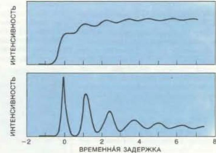
нии, имеющем и ионный, и ковалентный характер. Если иодид натрия распадается на атомы, то интенсивность части его спектра изменяется скачкообразно, как свидетельствуют экспериментальные результаты (вверху справа). Если же иодид натрия находится в высокозергетическом состоянии, то интенсивность части его спектра будет осциллировать (внизу справа).
