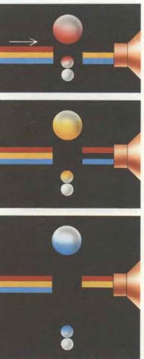
**СОСТОЯНИЕ МОЛЕКУЛЯРНОЙ** системы можно установить по спектру света, поглощенному молекулой. Когда атомы в молекуле находятся сравнительно близко друг к другу, они поглощают свет с большими длинами волн, например красный. Когда атомы расходятся на большее расстояние, они поглощают свет с меньшими длинами волн, например синий. Такое изменение спектра — это «отпечаток пальца» движущихся атомов.
