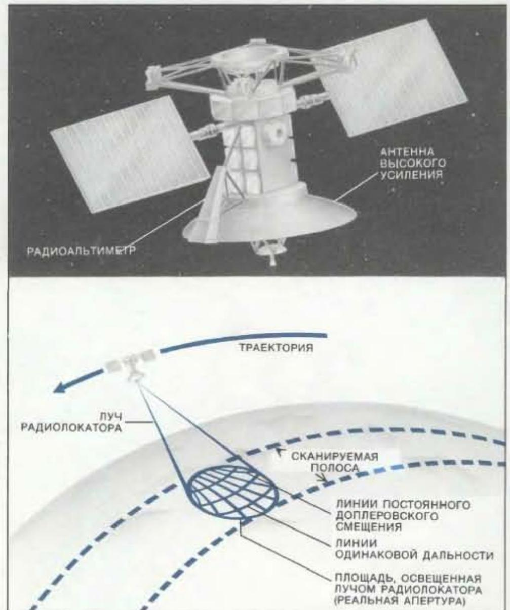
**АНТЕННА** с высоким коэффициентом усиления на «Магеллане» во время каждого витка полета сканирует полосу поверхности Венеры и передает данные на Землю. Из отдельных полос строится мозаичное изображение. Радиоальтиметр измеряет время, необходимое радиопульсу, чтобы, отразившись от поверхности, вернуться на автоматическую станцию. Из этих данных можно получить топографию поверхности.
