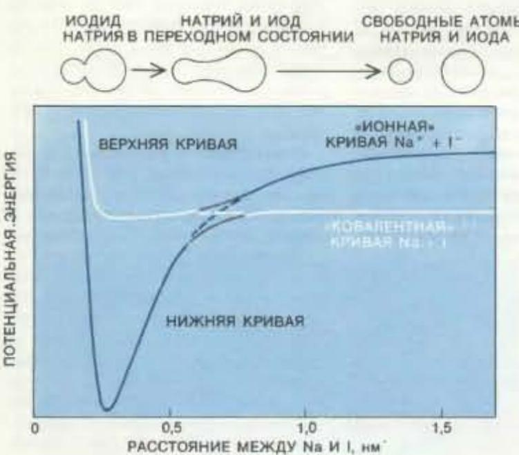
**ФЕМТОСЕКУНДНЫЕ ДВИЖЕНИЯ** молекулы иодида натрия ( $\text{NaI}$ ) выявляют молекулярную динамику химической связи между атомами натрия и иода. Слева на диаграмме потенциальной энергии «ионная» кривая (притяжение) пересекается с «ковалентной» кривой (отталкивание). В результате молекула иодида натрия может распасться на атомы натрия и иода, будучи ковалентной системой, или существовать в высокозергетическом связанном состоя-
