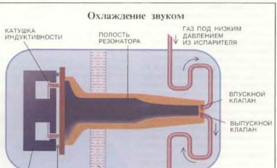
Звуковой компрессор приводится в действие как обычный громкоговоритель. Колебания создают в полости резонатора высокочастотную стоячую волну, которая сжимает газ-хладагент. Клапан выпускает газ к конденсатору, который сжижает и охлаждает его. Жидкость циркулирует в пространстве, которое необходимо охладить, испаряясь и поглощая тепло. Газ затем идет обратно в компрессор, и цикл повторяется.
