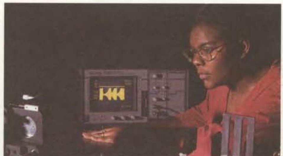
ЗЕЛДА ГИЛЛС, студент-дипломник Технологического института штата Джорджия, следит за интенсивностью излучения лазера, которая отображается на экране осциллографа в виде хаотических «вспышек». (Фото: М. Баррет, Технологический институт штата Джорджия.)
