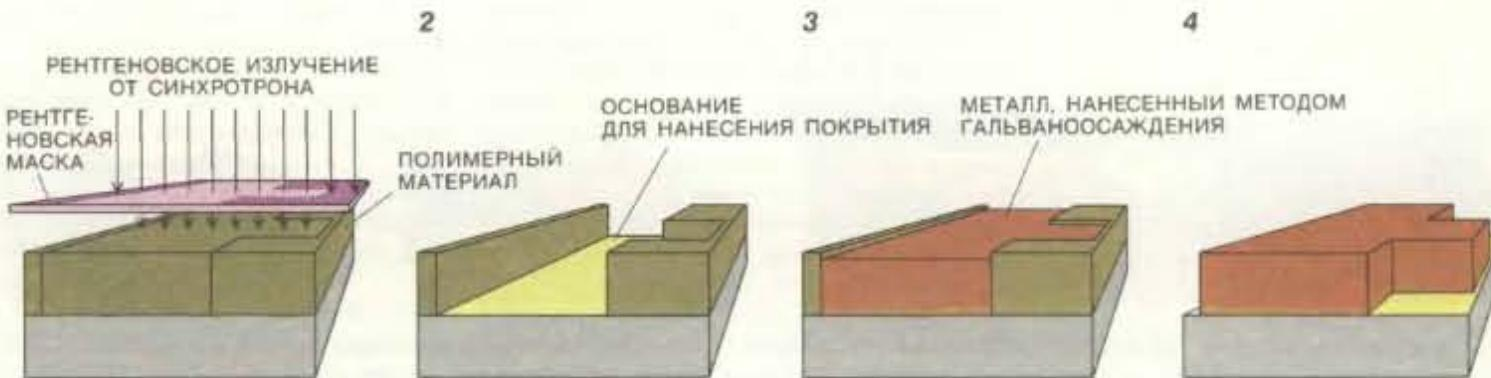
**ЛИТЬЕ ПОД ДАВЛЕНИЕМ** микроскопических структур можно выполнить с помощью процесса, разработанного в Центре ядерных исследований в Карлсруэ (Германия). Эта технология известна под названием **LIGA** — аббревиатура немецких слов *Litographie* (литография), *Galvanoformung*
