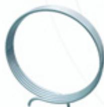
**Антенна СВ-диапазона** представляет собой катушку из медной проволоки, намотанной на ферритовый стержень, который улавливает магнитную составляющую трехсотметровых радиоволн. Такая конструкция менее эффективна, но зато более удобна, чем диполь длиной 150 м.
