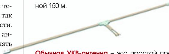
**Обычная УКВ-антенна** – это простой проволочный диполь, улавливающий электрическую составляющую электромагнитного излучения. Его длина составляет от одного до полутора метров, что соответствует половине длины ультракоротких волн.
