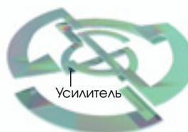
**В активной телевизионной антенне** имеются небольшие усилители, питаемые постоянной составляющей наведенного тока. Они соединены с угловыми приемными элементами, расположенными в середине круглого основания. Часто этими компактными и легкими антеннами снабжают спутниковые тарелки, неспособные принимать обычные телепередачи.
