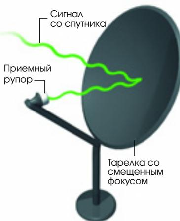
**Спутниковая тарелка** фокусирует радиоизлучение на рупорной антенне малошумящего СВЧ-приемника. В старых параболических антеннах приемный рупор и его крепление затеняли раскрыв отражателя, снижая эффективность системы до 50–55%. В современных конструкциях элементы приемника располагаются под тарелкой со смещенным фокусом, благодаря чему эффективность возрастает до 80%.
