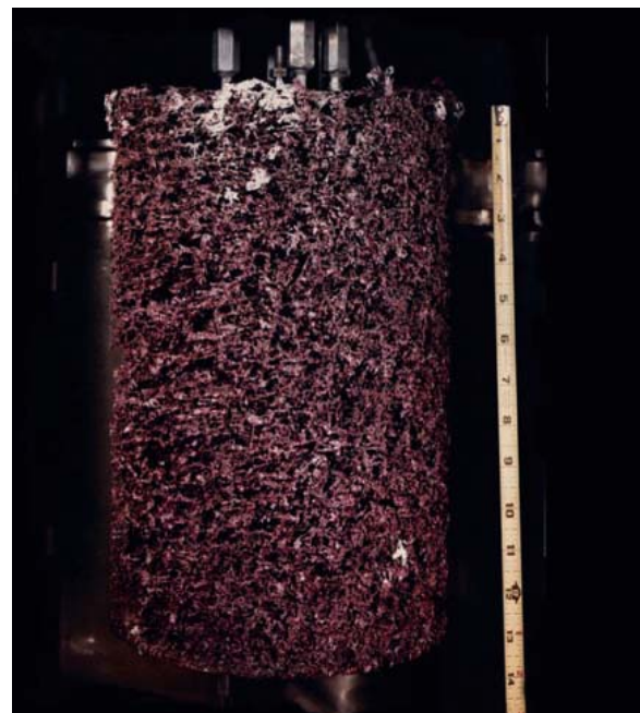
ИЗВЛЕЧЕННЫЕ из отработанного топлива тепловых реакторов уран и актиниды в ходе пиропереработки осаждаются на катоде установки для электрорафинирования. После переработки металлическое топливо можно использовать в реакторах на быстрых нейтронах.
