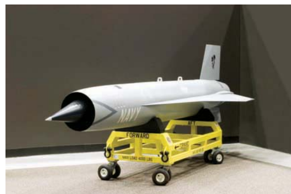
Быстрая и неистовая: крылатая ракета типа RATTLRS сможет ставить рекорды скорости благодаря воздухозаборнику с изменяющейся геометрией и новому двигателю
