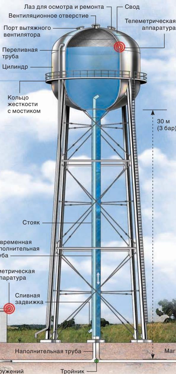
**РАЗМЕЩЕНИЕ:** для обеспечения надлежащего напора в системе резервуар должен быть расположен выше всех жилых зданий. На равнинах строят водонапорные башни, в холмистой местности резервуары устанавливают на возвышенностях, а в городах — на крышах зданий, а насосы размещают в подвалах
