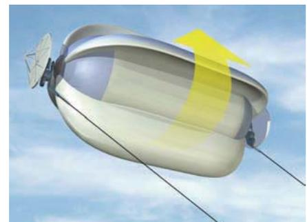
Наполненный гелием ротор будет ловить ветер тканевыми лопатками и вращать генераторы, закрепленные на тросах, по которым электричество будет передаваться на Землю
