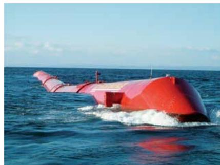
Волновой электрогенератор, разработанный компанией *Ocean Power Delivery*, вырабатывает электричество, прогибаясь в местах соединения отсеков при прохождении под ними волн. Энергоустановка *Pelamis* подныривает под высокие волны, и поэтому сильные штормы ей не страшны
