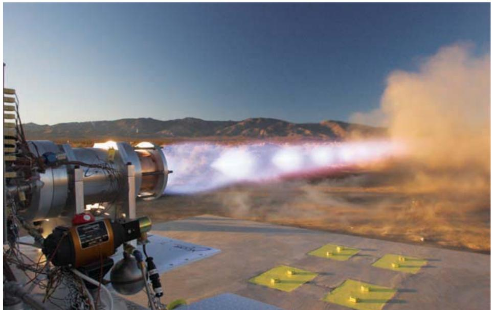
На рисунке видны конусы ударной волны метанового двигателя, наземные испытания которого были проведены в декабре прошлого года компанией *XCOR Aerospace*. Возможно, в будущем такие двигатели будут использоваться на космических кораблях
