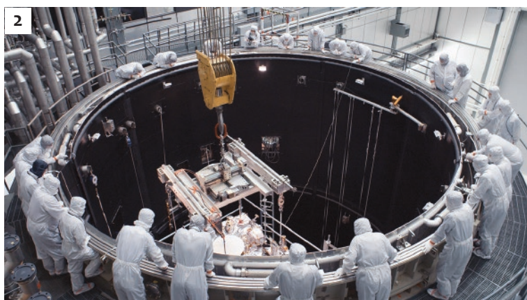
Путешествие зонда OSIRIS-REx к Бенну началось 12 годами ранее его запланированного запуска на сентябрь 2016 г. Сначала космический аппарат был собран (1), а затем прошел испытания в вакуумной камере (2) и акустических лабораториях (3) в Центре космических систем компании Lockheed Martin в Литлтоне, штат Колорадо.
