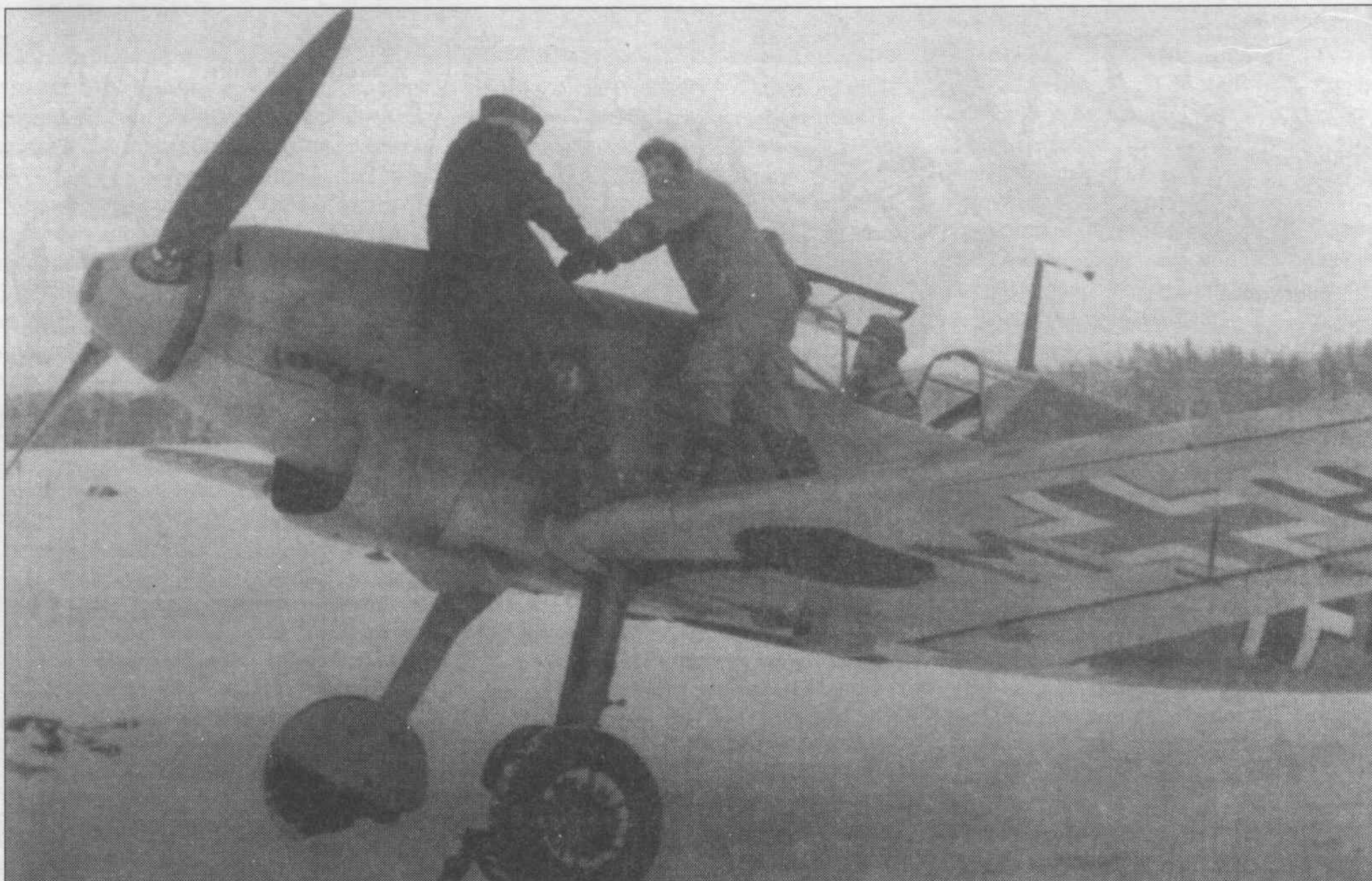
Me 109В в одной из летных школ, зима 1940/41 г.г. Самолет несет новый камуфляж (71/02) и опознавательные знаки (кресты с широким белым кантом). Обратите внимание на заглушку на конце обтекателя винта. На крыле видны укороченные предкрылки, а маслорадиатор находится в положении, характерном для ранних «Берт». При этом выхлопные патрубки характерные для машин, выпущенных после 1938 года.
