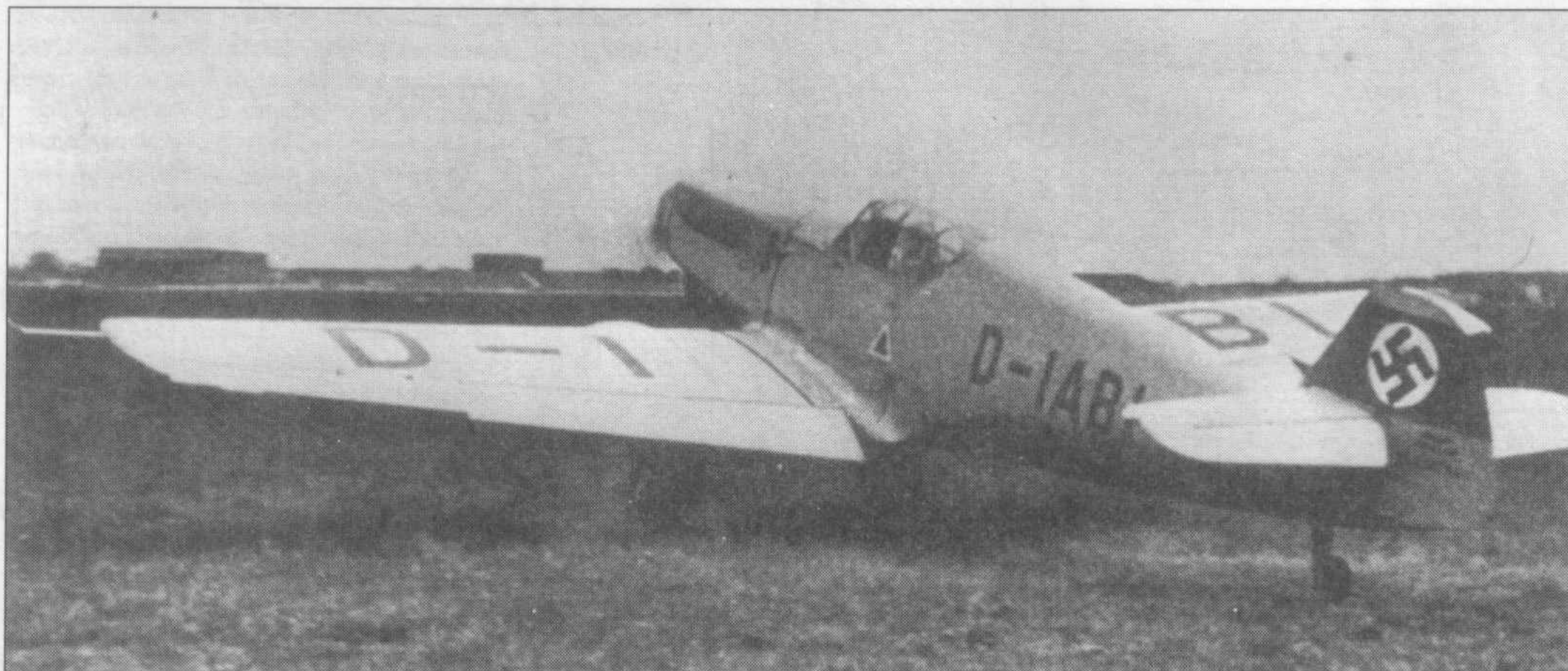
Me 109a вырывается на старт. Обратите внимание на выступы на верхней части крыльев, вызванные использованием шасси с широкими покрышками. Такое техническое решение позднее использовали на Me 109G/K. На руле направления видны информационные надписи, указывающие технические характеристики самолета.
