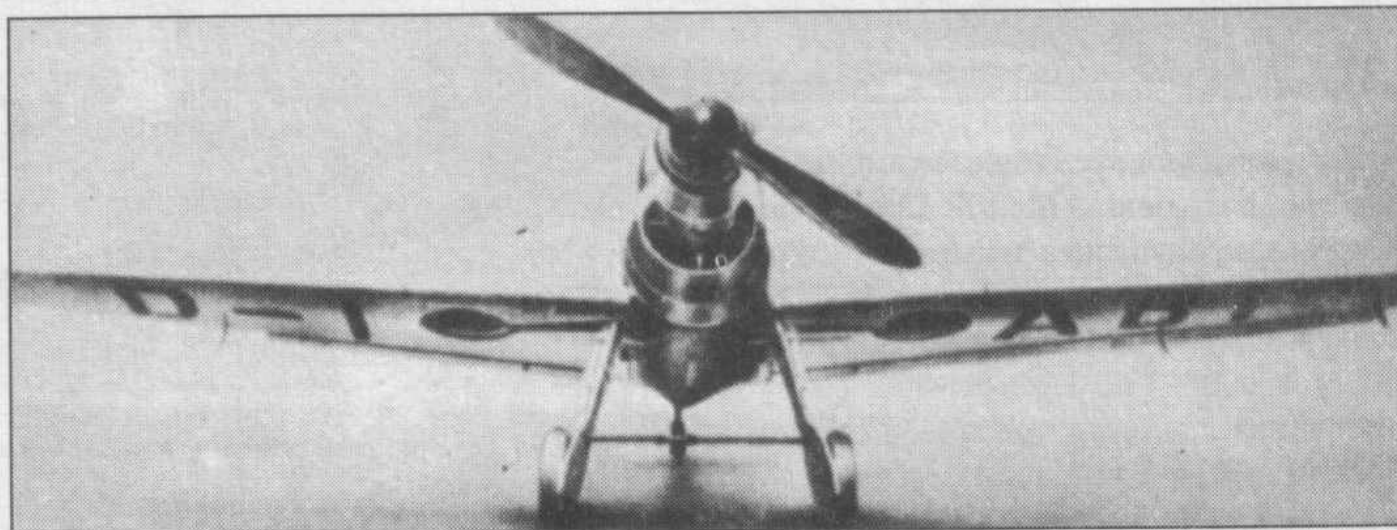
Me 109a, оснащенный двигателем Kerstel V, (D-IABI). Распорка между шасси использовалась во время начального периода испытаний.
