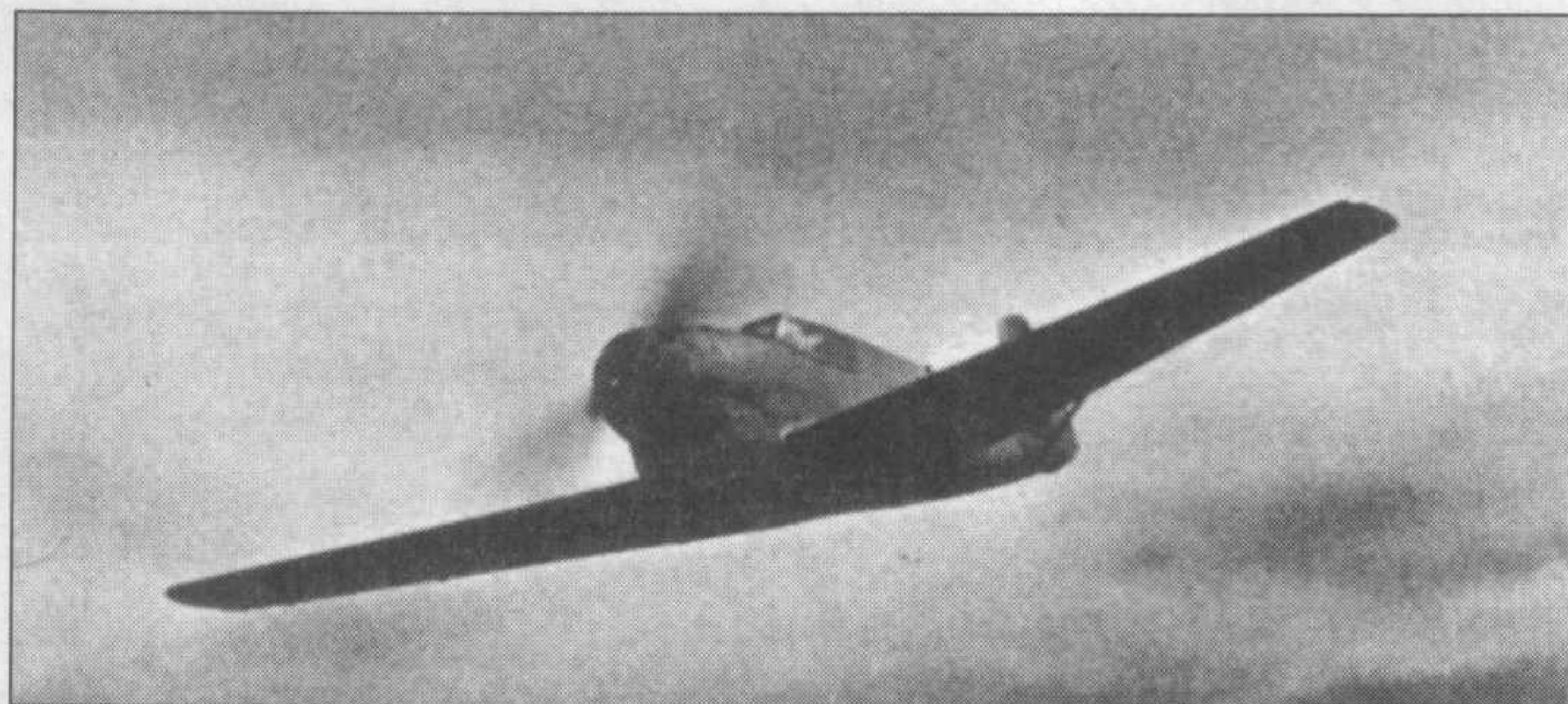
Обратите внимание на отсутствие антенной мачты и хвостового колеса на V3. Если мачту могли заретушировать, то колесо вполне могло быть убрано в полете.
