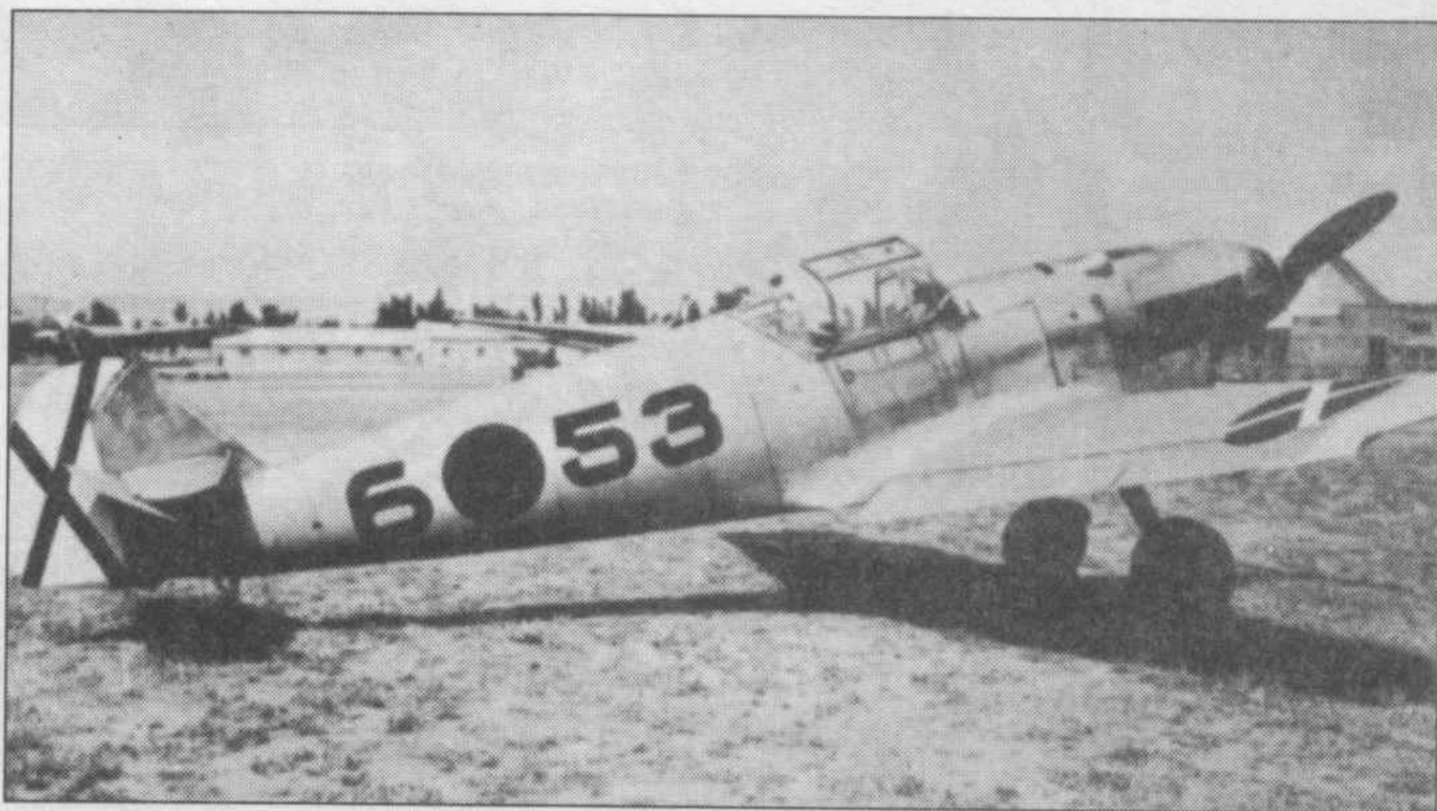
Эту известную фотографию часто описывают как Me 109B-2 или как Me 109D-1. Правы те, кто считает данный самолет легиона «Condor» «Дорой». Дополнительный амортизатор на хвостовом колесе указывает на принадлежность к одной из самых первых серий.
