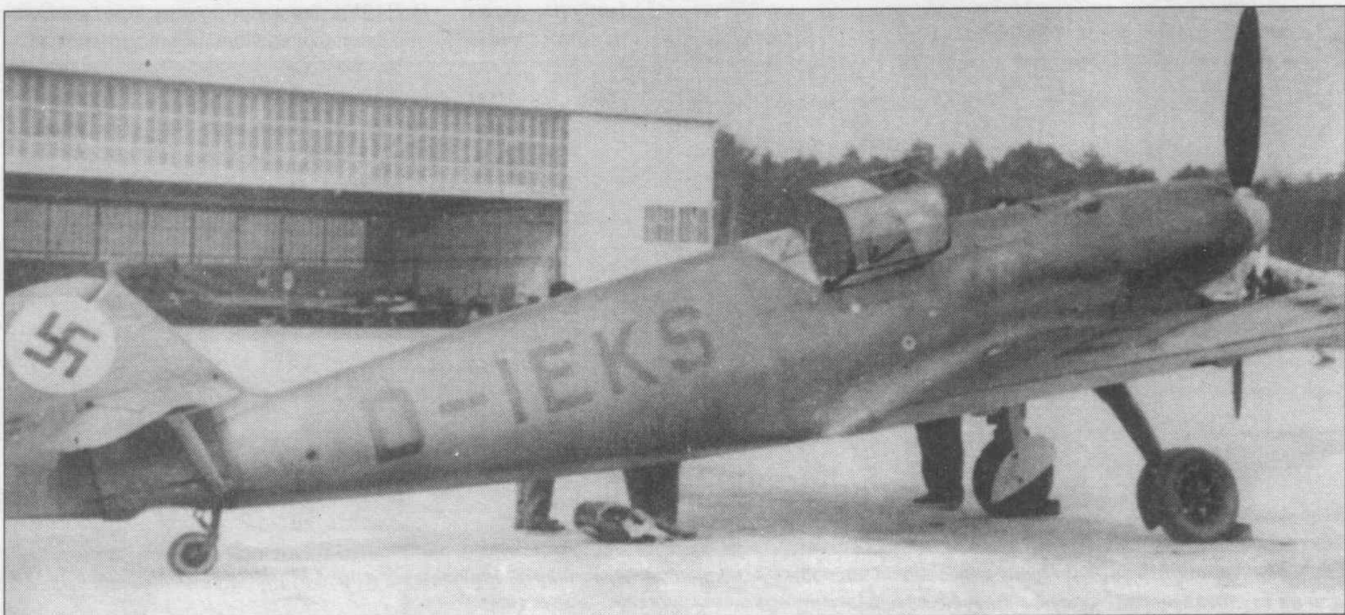
Два снимка Me 109B-0 (D-IEKS), сделанные зимой 1936/37 г.г. на заводском аэродроме в Аугсбурге. Самолет имеет ряд особенностей, характерных для серии B-0: отсутствуют пулеметы и радиостанция, укорочены предкрылки, маслорадиатор под левым крылом. Обтекатель втулки винта, похоже, выкрашен в желтый цвет.
