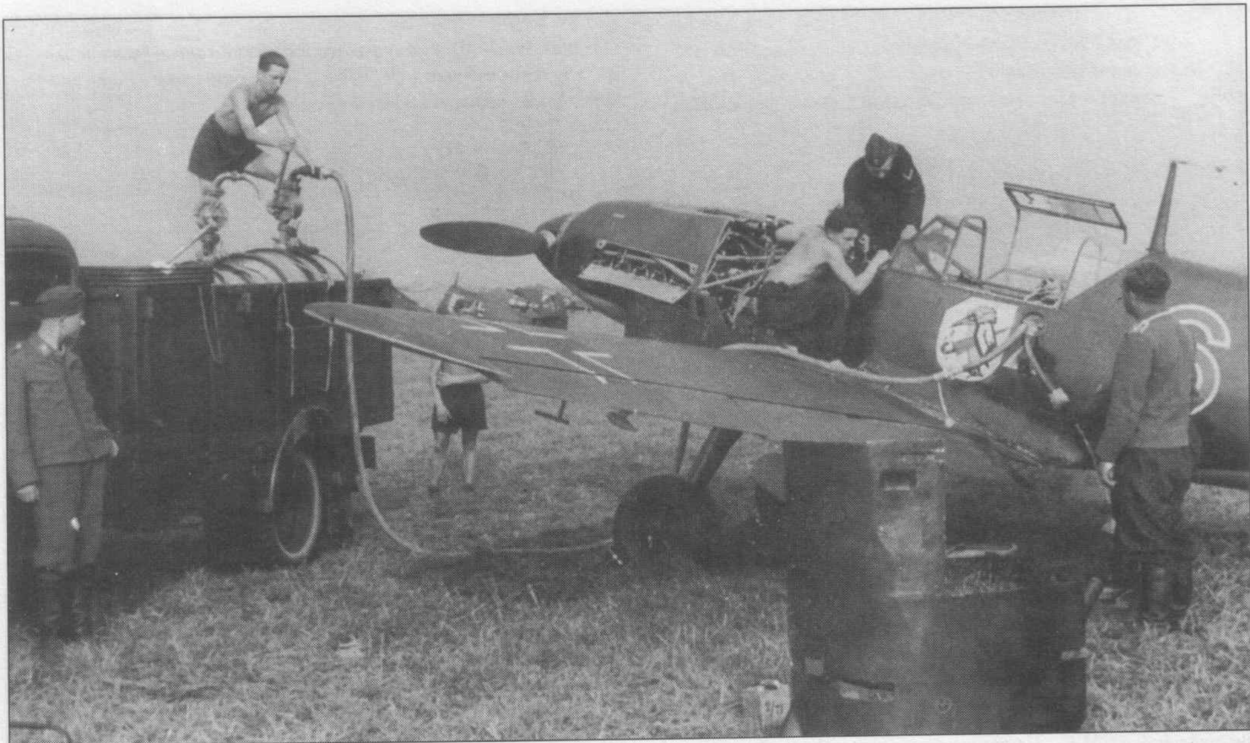
Me 109D из I./JG 71, позднейшей II./JG 51. Идет подготовка к боевому вылету. На переднем плане лежит снятая деталь капота, закрывающая пулеметный отсек. Видна часть моторамы и серые детали пулеметов.
