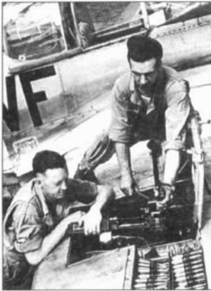
Два оружейника извлекают перекошенный патрон из пулемета P-51G, 33rd FS, 4th FG, Англия, 1944 год.
