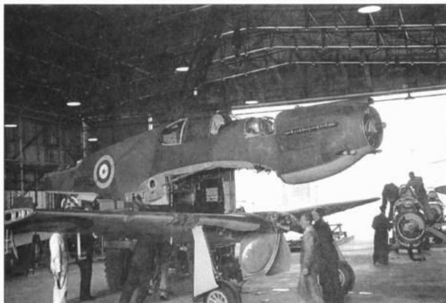
Монтаж «Мустанга», Англия, 1942 год. Установка фюзеляжа на крылья. Справа видны фюзеляжи других «Мустангов».
