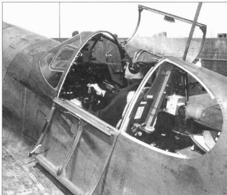
Вид на кабину пилота P-51A-1-NA (43-6055). Виден отсек радиостанции. Обратите внимание на то, что бронеспинка кресла крепится к противокapotажной дуге. Видны створки фонаря.
