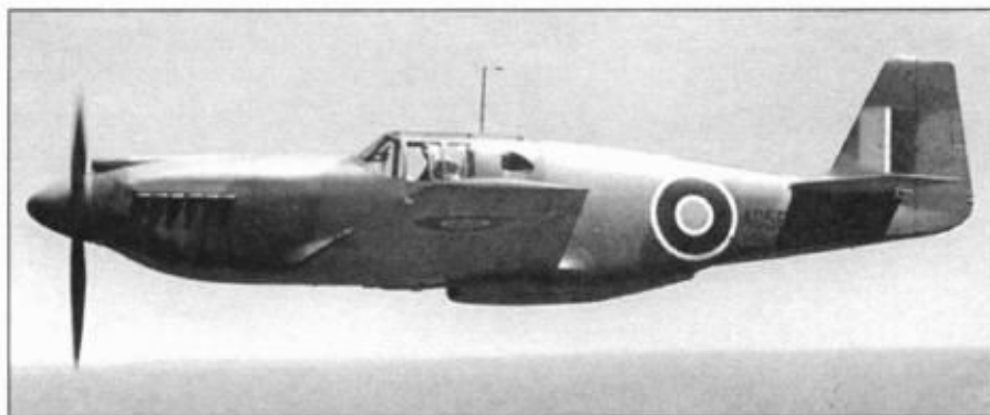
«Мустанг I» в полете, 1942 год. Снимок сделан с борта «Гудзона». За кабиной истребителя установлена фотокамера.
