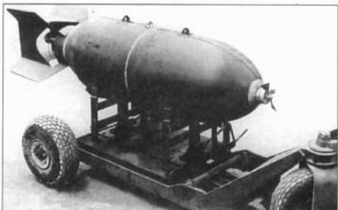
500-фунтовая (227 кг) бомба на тележке с гидравлическим подъемником. «Мустанг» мог брать две такие бомбы.
