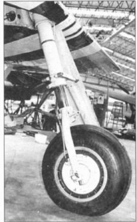
Левая стойка шасси, вид изнутри.
