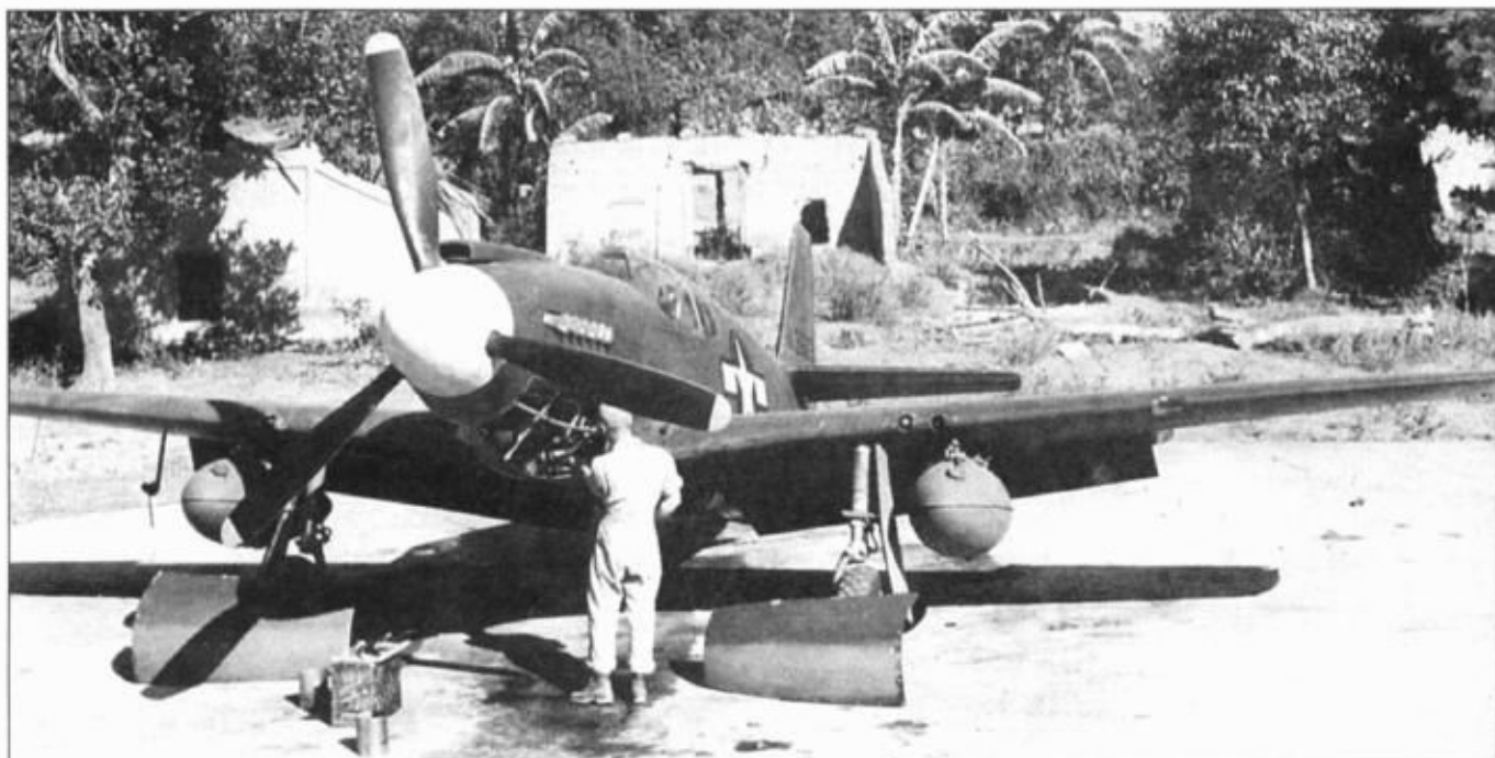
Р-51А из 311-й истребительно-бомбардировочной группы. Самолет оснастили двумя подвесными баками по 75 галлонов, Юго-Восточная Азия, 1944 год.
