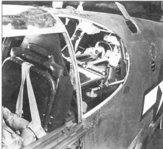
Задняя часть кабины P-51B-7-NA. Виден стеллаж для приемопередатчика и аккумулятора. Сразу за креслом виден дополнительный бензобак и его дренажная трубка.
