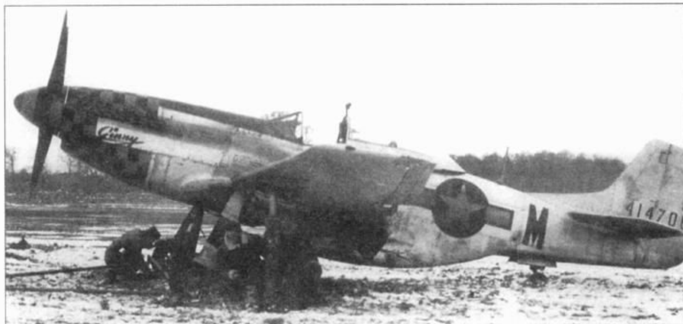
Механики подвешивают бомбы под «Мустанг» командира 39-й эскадрильи. На переднем плане видны уложенные бомбы.
