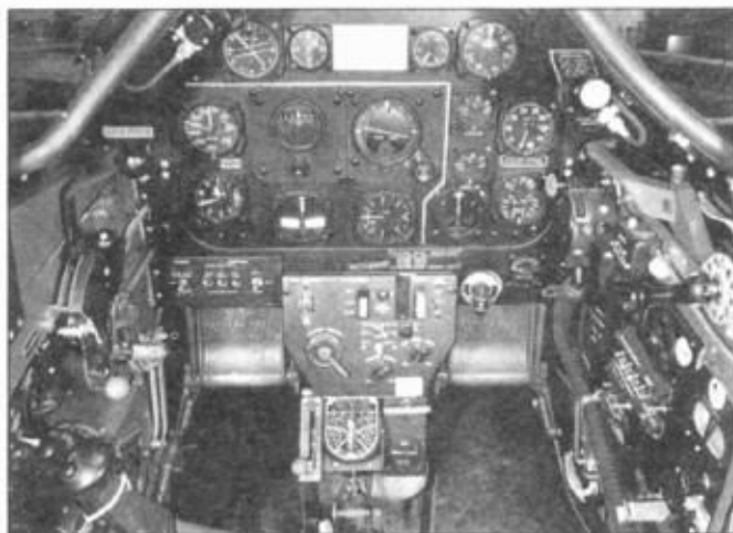
Кабина P-51D-5. Видна разница в дизайне главной приборной доски, панели стартера и расположении органов управления по бортам кабины.
