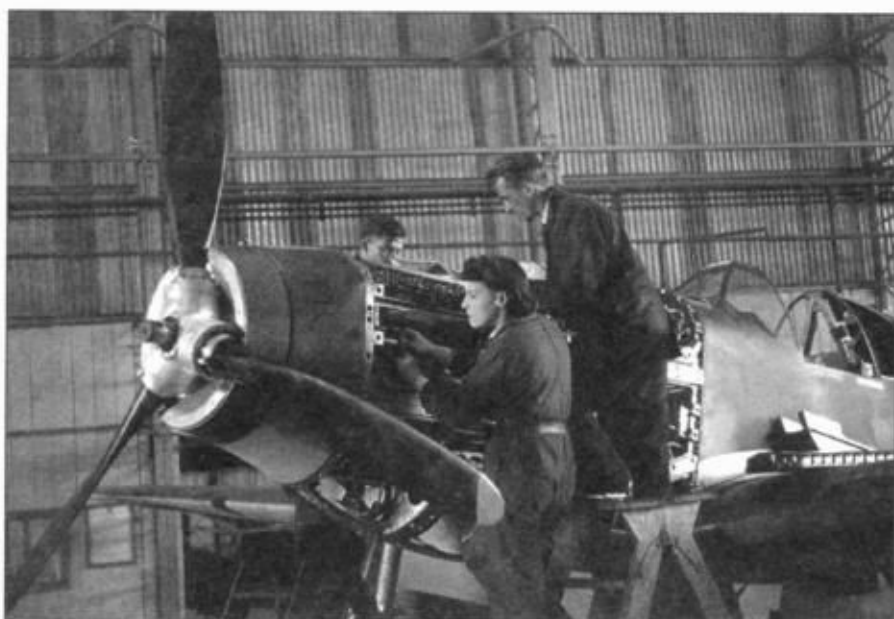
Еще один снимок процесса сборки «Мустанга» в Англии. Идут работы в двигательном отделении.
