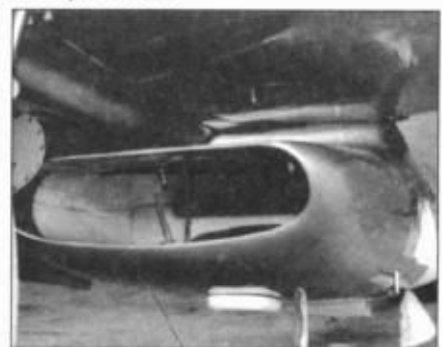
Воздухозаборник радиатора под фюзеляжем P-51D. Самолет из коллекции музея в Даксфорде.
