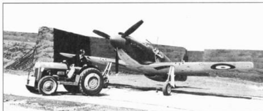
Новый «Мустанг I» буксируется из защитного убежища, Англия, 1941 год. Обратите внимание на разную высоту пулеметных портов в крыле. 7,62-мм пулеметы расположены выше, а 12,7-мм - ниже.
