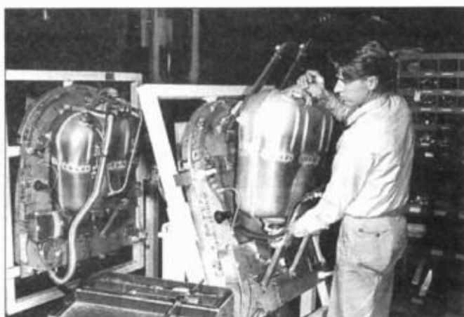
Присоединение маслобака к противопожарной переборке.
