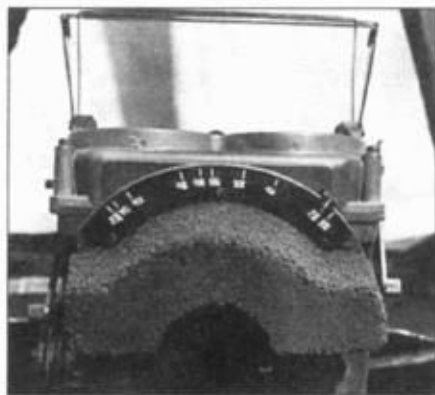
Коллиматорный прицел К-14А устанавливался над приборной доской. Виден губчатый амортизатор, предохраняющий лицо пилота от удара о прицел в случае аварии.
