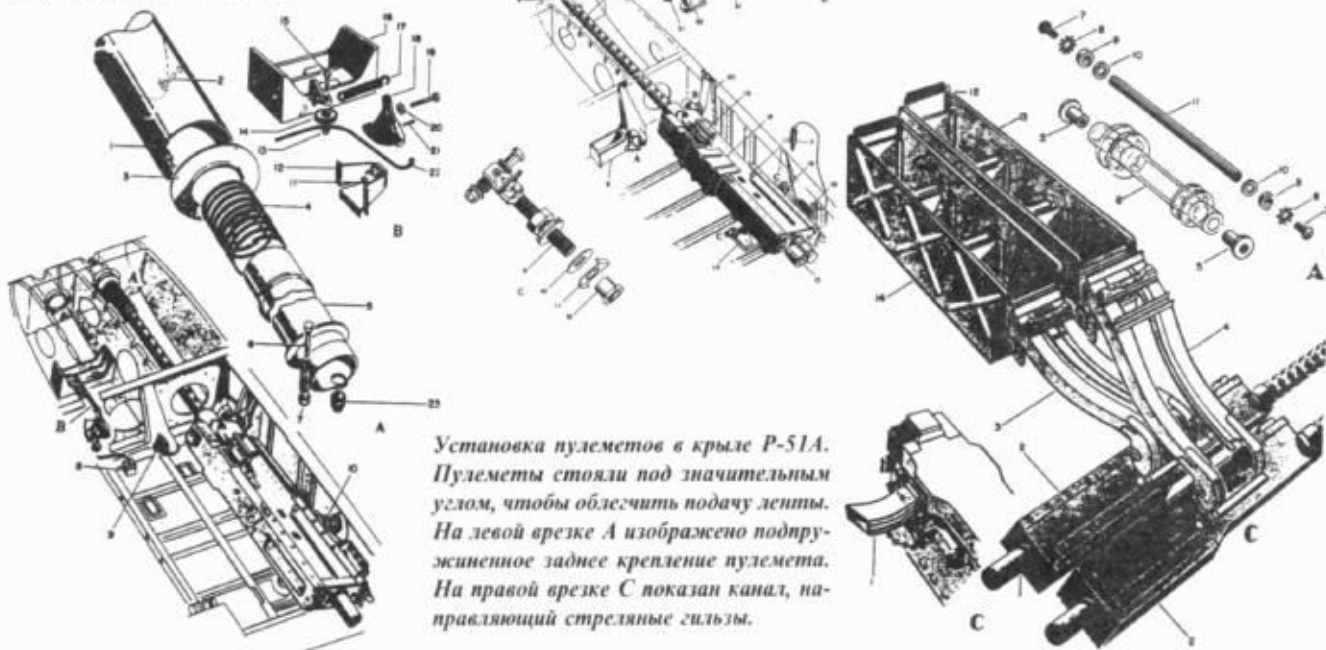
Патронные ящики и особенности их крепления в крыле P-51B/C.
