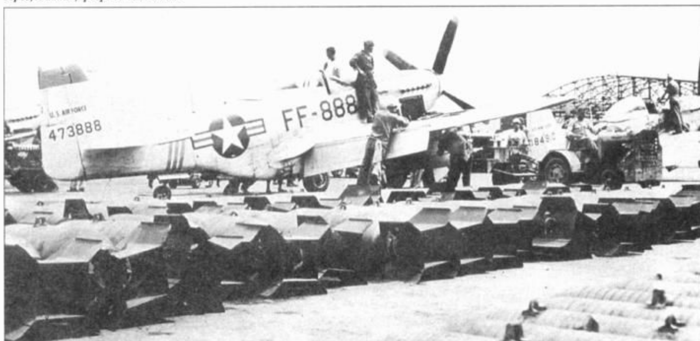
Механики подвешивают бомбы под «Мустанг» командира 39-й эскадрильи. На переднем плане видны уложенные бомбы.
