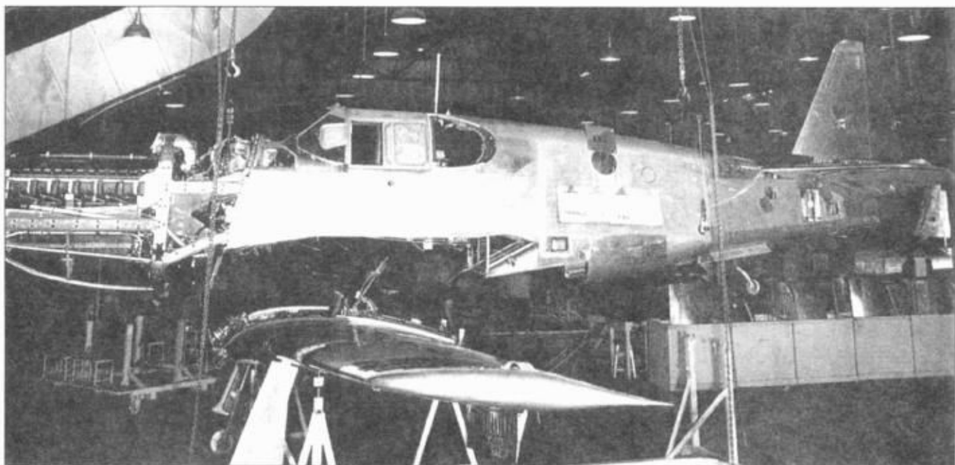
Соединение фюзеляжа P-51A с крылом.
