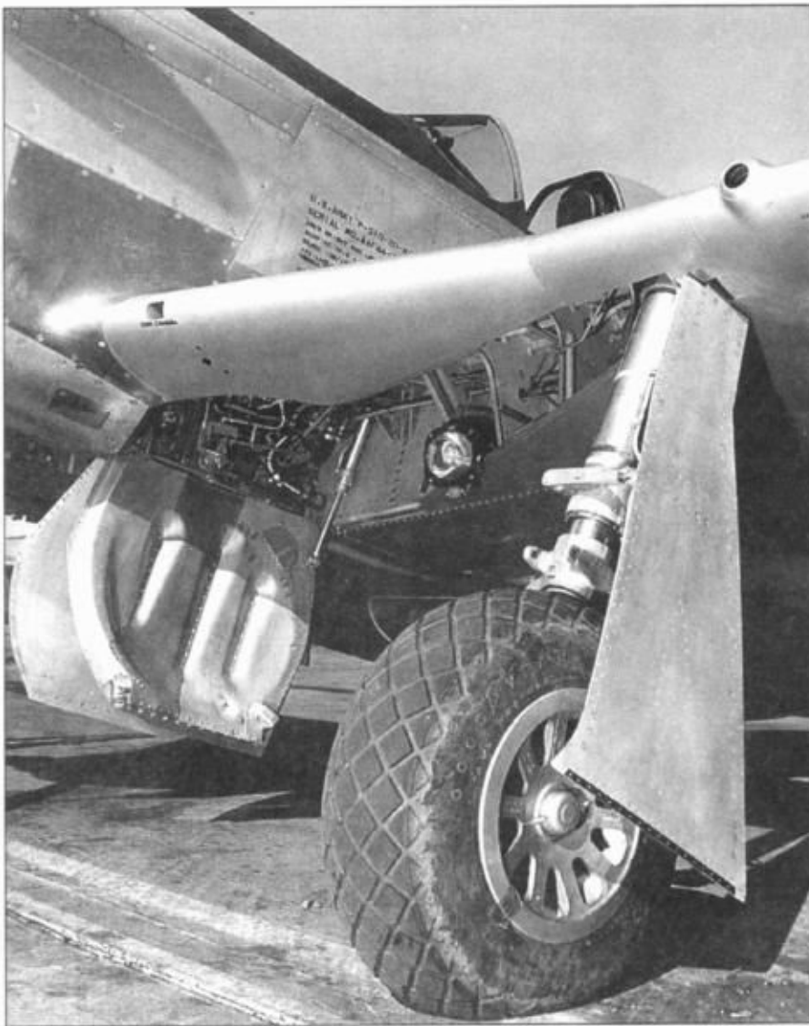
Левая стойка шасси P-51D с посадочным прожектором. Хорошо видна внутренняя сторона створки колесной ниши и ее тяга.
