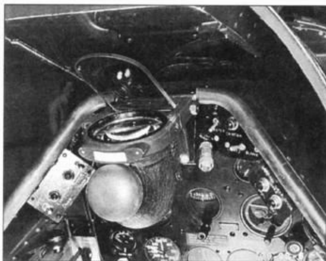
Коллиматорный прицел N-9 на P-51D. Перед прицелом стоит пятилопастное бронестекло толщиной 38,1 мм (1,5 дюйма).
