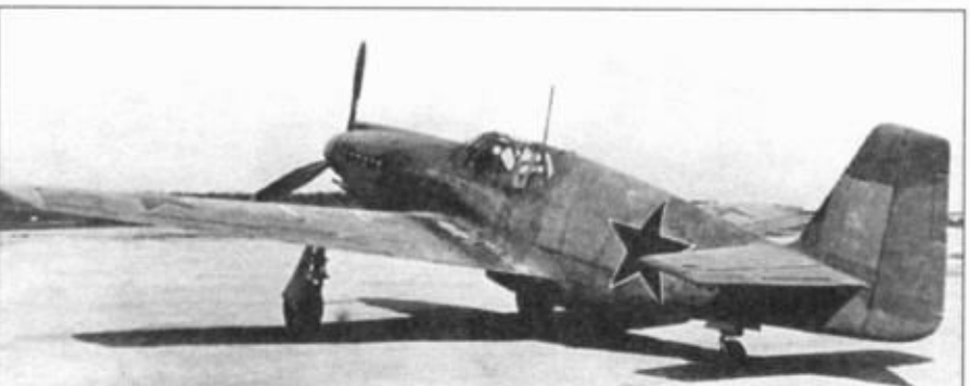
Этот же самолет, переданный англичанами Советскому Союзу. Камуфляж английский, опознавательные знаки советские. Воздухозаборник уже перенесен вперед.
