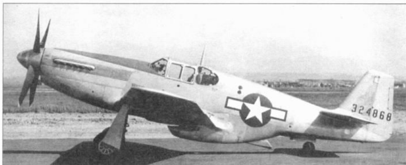
Некамуфлированный P-51B-15 (43-24868). 1955-й экземпляр из 1988 «Мустангов» этой серии. Видна антибликовая панель перед кабиной пилота, закрашенная в цвет Olive Drab. Серийный номер на некамуфлированных «Мустангах» наносился черной краской.
