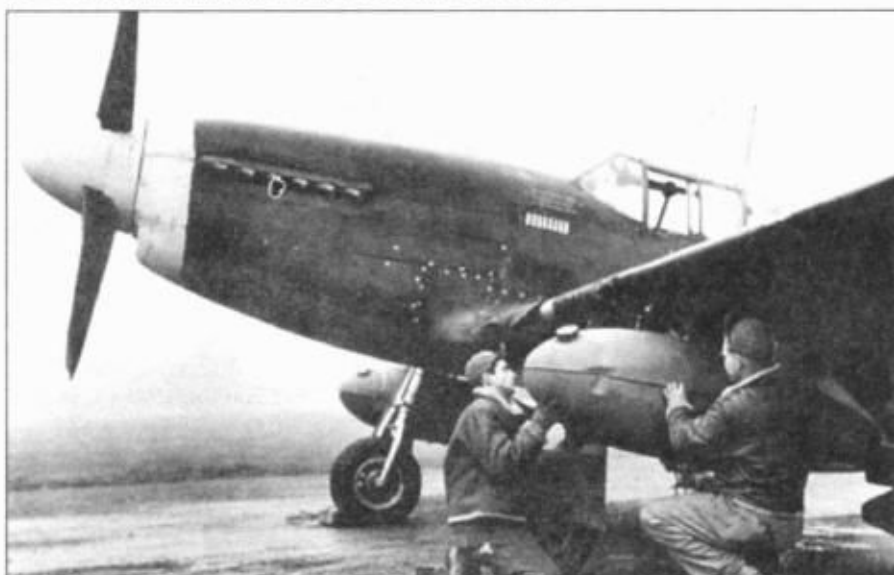
Бак емкостью 75 галлонов (280 л), подвешенный под крыло P-51C. Перед кабиной видны обозначения восьми боевых вылетов. На этом самолете летал лейтенант Дж.Ф. Толланд.
