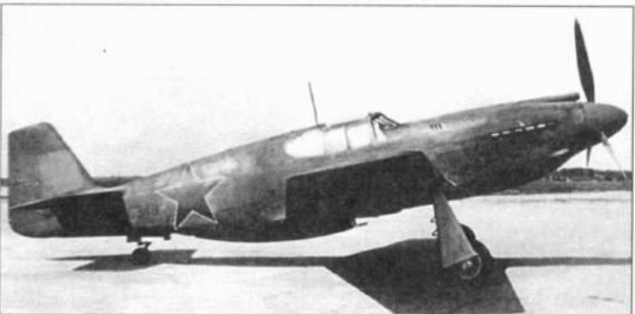
Четвертый серийный «Мустанг I» (AG348). Самолет еще имеет укороченный воздухозаборник карбюратора. После испытаний в Боском-Даун было решено вывести воздухозаборник сразу за винтом. Снимок сделан еще в Штатах.
