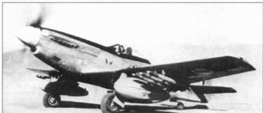
«Мустанг» 2-й южноафриканской эскадрильи «Flying Cheetah». Самолет несет под крыльями шесть ракет и два подвесных бака. Кок винта оранжевого цвета, а панель перед кабиной - черная.
