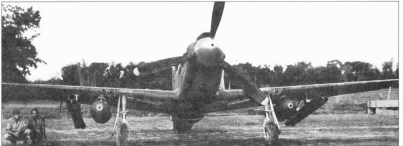
Оснащенный двумя трехтрубными ракетными установками и двумя 227-кг бомбами P-51A из 311-й группы, Динджит, Индия, 1944 год.
