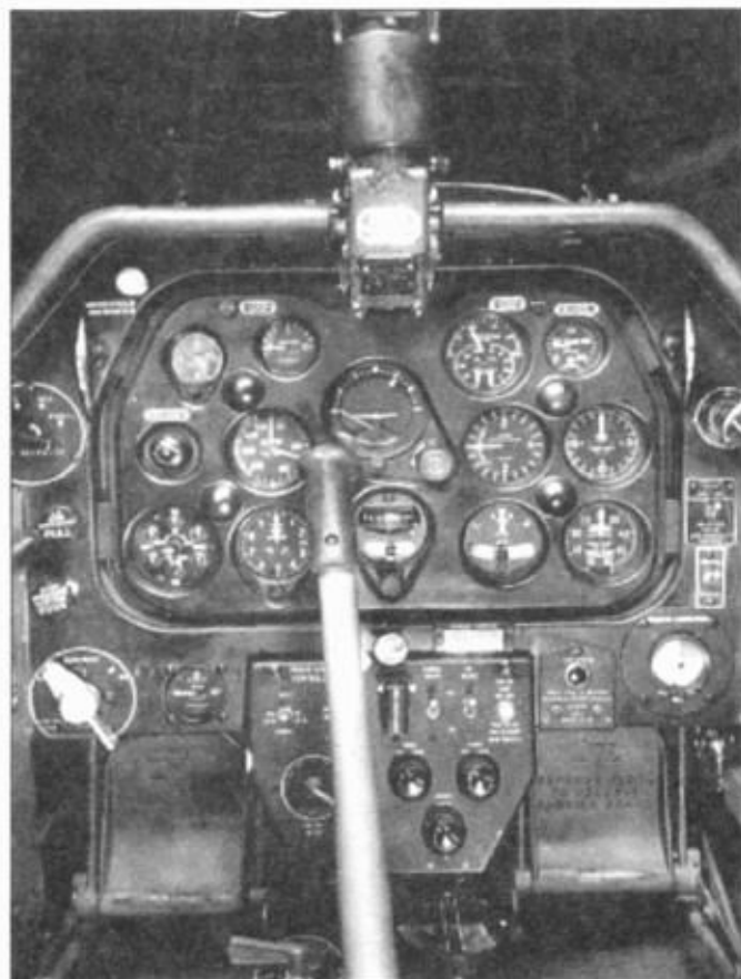
Главная приборная доска XP-51. Она почти не отличалась от приборной доски «Мустанга I», выпускавшегося для Британии. На переднем плане видна традиционная американская ручка управления. В верхней части снимка заметен коллиматорный прицел ST1A, слева от него вспомогательный концентрический прицел. Под главной приборной доской находится дополнительная панель, на которой собраны органы управления стартером.
