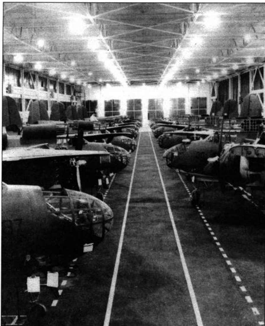
Основное производство самолетов «Дуглас» А-20 находилось в Санта-Монике. Там было изготовлено 808 машин. «Боинг» по лицензии построил еще 140. Самолеты обоих производителей почти не различались между собой. Имелись только небольшие особенности в разводке электрических кабелей и конструкции воздухозаборника карбюратора.
