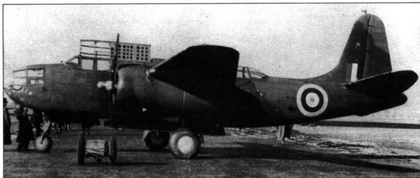
«Тербилайт» в необычном серо-зеленом камуфляже. Этот самолет использовался для подготовки экипажей в 307-й (польской) эскадрилье Королевских ВВС. В носовом сегменте самолета установлен мощный прожектор, который предполагалось использовать для подсветки целей ночью.
