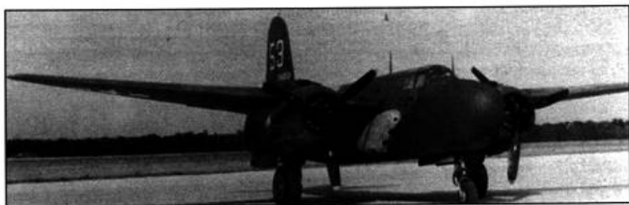
Единственным Р-70В-1 стал А-20G-10, оснащенный американским радаром SCR-720, работающим в сантиметровом диапазоне. Радар находился в носовом сегменте фюзеляжа, а шесть 12,7-мм пулеметов двумя батареями по три пулемета размещались под обтекателями по бортам в районе кабины пилота.
