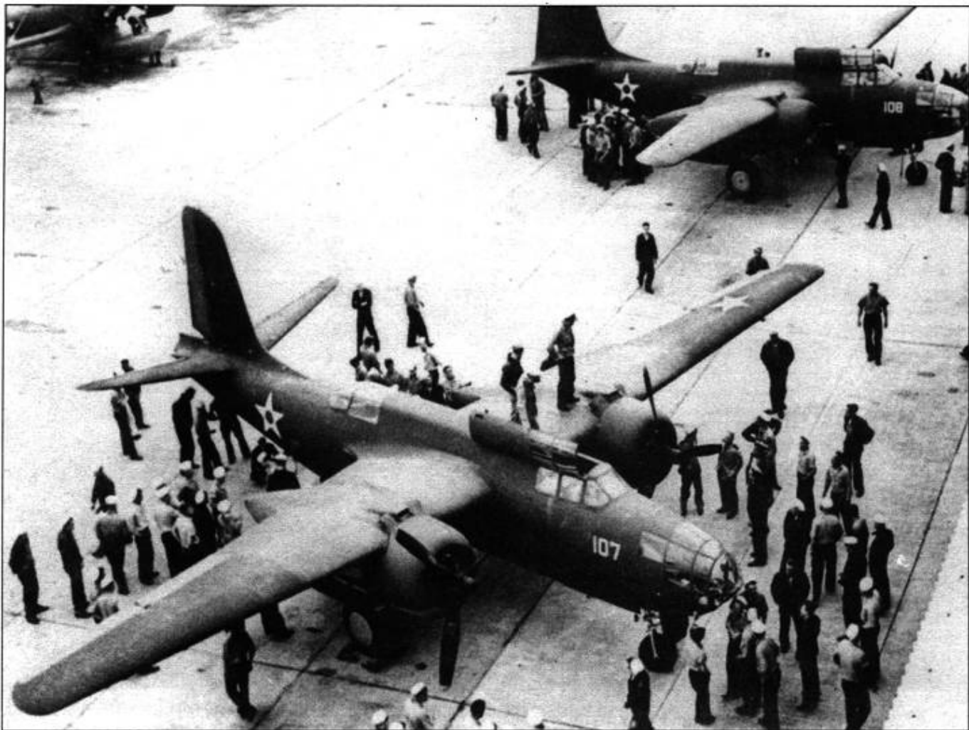
Военные моряки и морские пехотинцы осматривают DB-2 - морскую версию А-20В. Этот самолет использовался в качестве буксира учебных воздушных целей. Всего морская авиация получила восемь таких машин.
