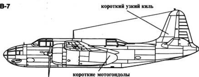
DB-7A отличался от DB-7 более мощными 1600-сильными двигателями «Райт R-2600-A5B». Внешне самолет можно было отличить по более длинным мотогондолам и более высокому килю. Эти самолеты выпущены для Франции, но достались Великобритании.
