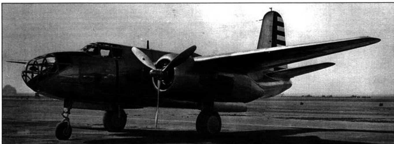
A-20A почти не отличался от A-20, лишь в мотогондолах отсутствовали турбонаддувы. Внешне A-20A почти не отличались и от DB-7.
