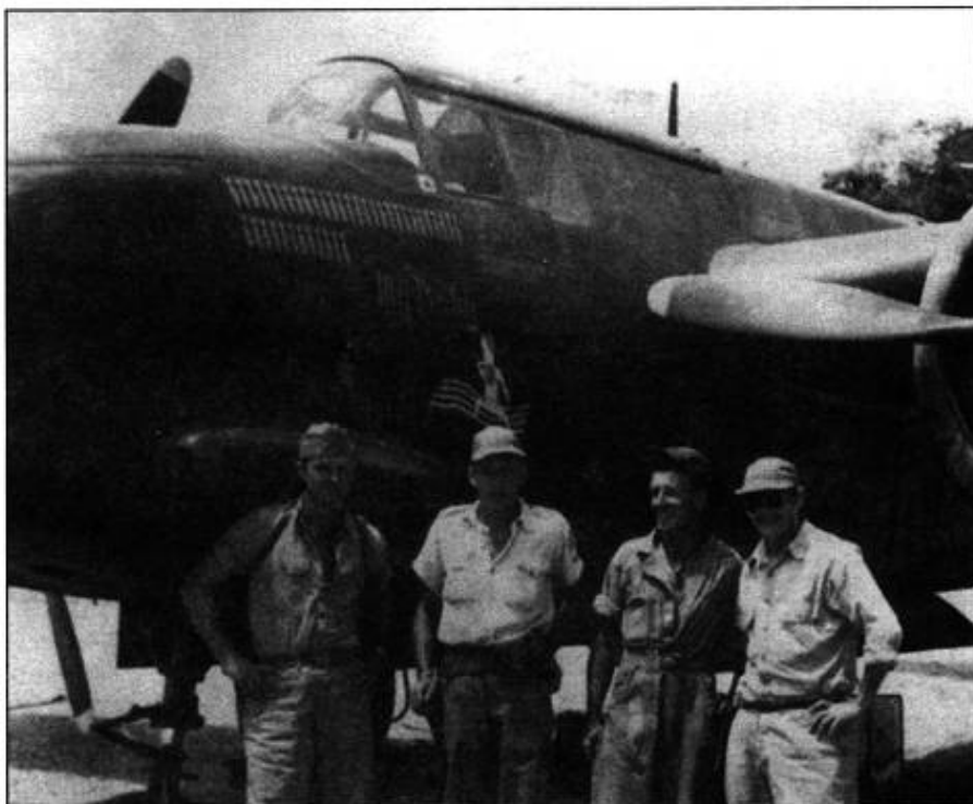
«Му Вабу» совершил 39 боевых вылетов к концу 1942 или началу 1943 года. Вентиляционные отверстия на капоте говорят о том, что это А-20А. Плексигласовые иллюминаторы на носу закрашены, на месте кабины бомбардира установлена батарея из четырех 12,7-мм пулеметов.
