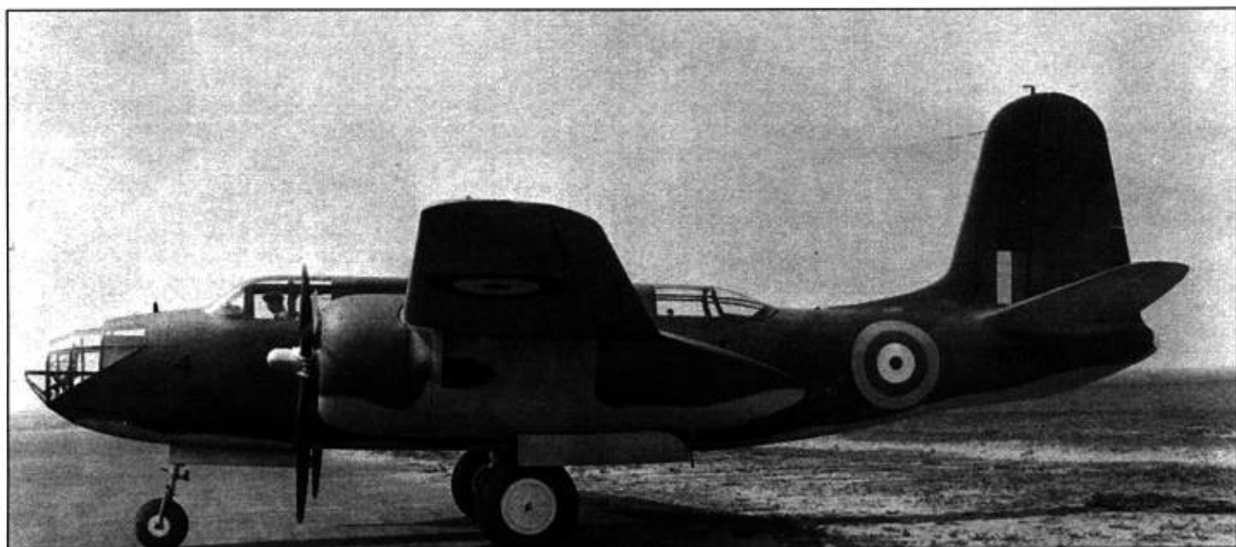
Англичане также заказали себе партию самолетов DB-7. Особенность британских машин заключалась в остеклении носовой части, вооружении и оснащении. Фюзеляж самолета стал немного длиннее.
