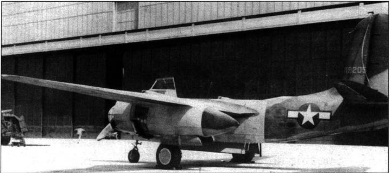
Этот А-20С оснастили усиленным бронированием. Самолет предполагалось использовать для испытания эффективности зенитных снарядов.
