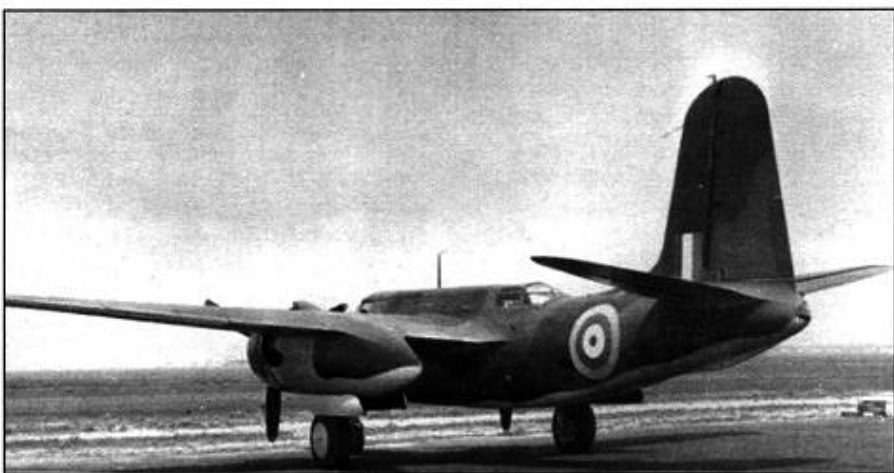
Англичане присвоили самолету название «Бостон». К названию прибавлялась римская цифра, которая обозначала модель самолета. Так, DB-7B стали называться «Бостон III». Место стрелка сверху закрывалось двухстворчатым фонарем, одна из створок которого сдвигалась вперед. Стрелок располагал одним или двумя пулеметами. Небольшое овальное пятно у кокарды на борту фюзеляжа - иллюминатор нижней пулеметной установки.
