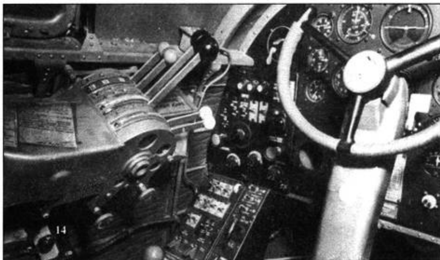
Ручка газа, ручка управления шагом винтов (левая консоль).
