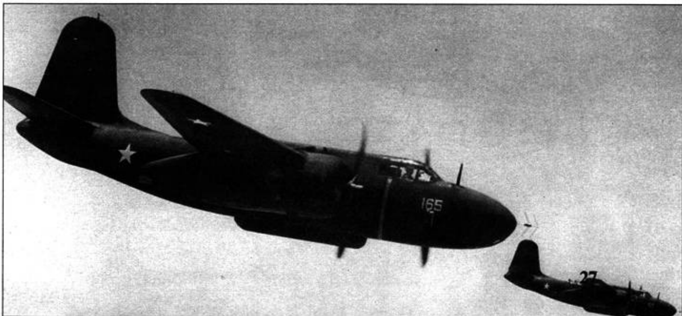
Два P-70 отрабатывают полет в строю. Оснащенный английским радаром AI Mk.IV, P-70 стал первым американским ночным истребителем, применявшимся на фронте. Место оператора радара оборудовали в прежней кабине стрелка, массивный радар смонтировали в носовой части фюзеляжа. Плексигласовые иллюминаторы в носовом сегменте закрасили.
