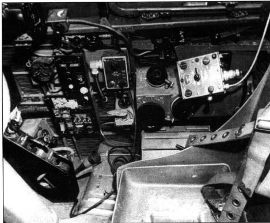
Задняя часть правой консоли, кресло пилота. Изнутри кабину окрашивали краской Zinc Chromate Green .
