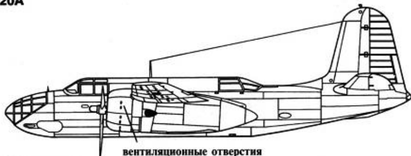
A-20A почти не отличался от A-20, лишь в мотогондолах отсутствовали турбонаддувы. Внешне A-20A почти не отличались и от DB-7.
