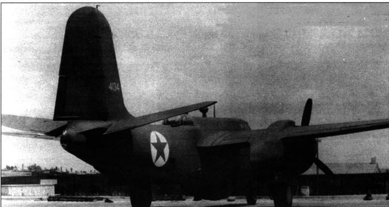
Советский Союз получил около 3000 штук А-20 разных модификаций. Этот А-20G оснащен подвесным баком, какой использовали при перегоне самолетов из США в СССР.
