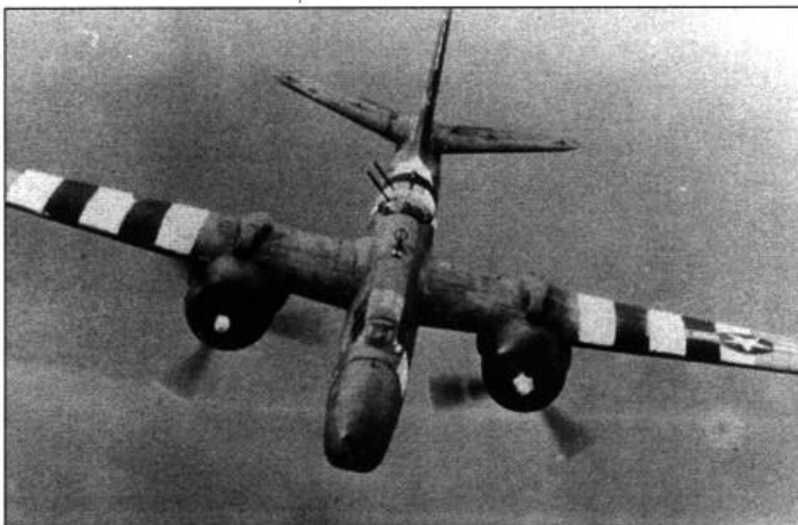
Перед началом операции «Оверлорд» союзническая авиация получила черно-белые полосы на фюзеляж и крылья, служившие для быстрой идентификации машин, участвовавших в операции.
