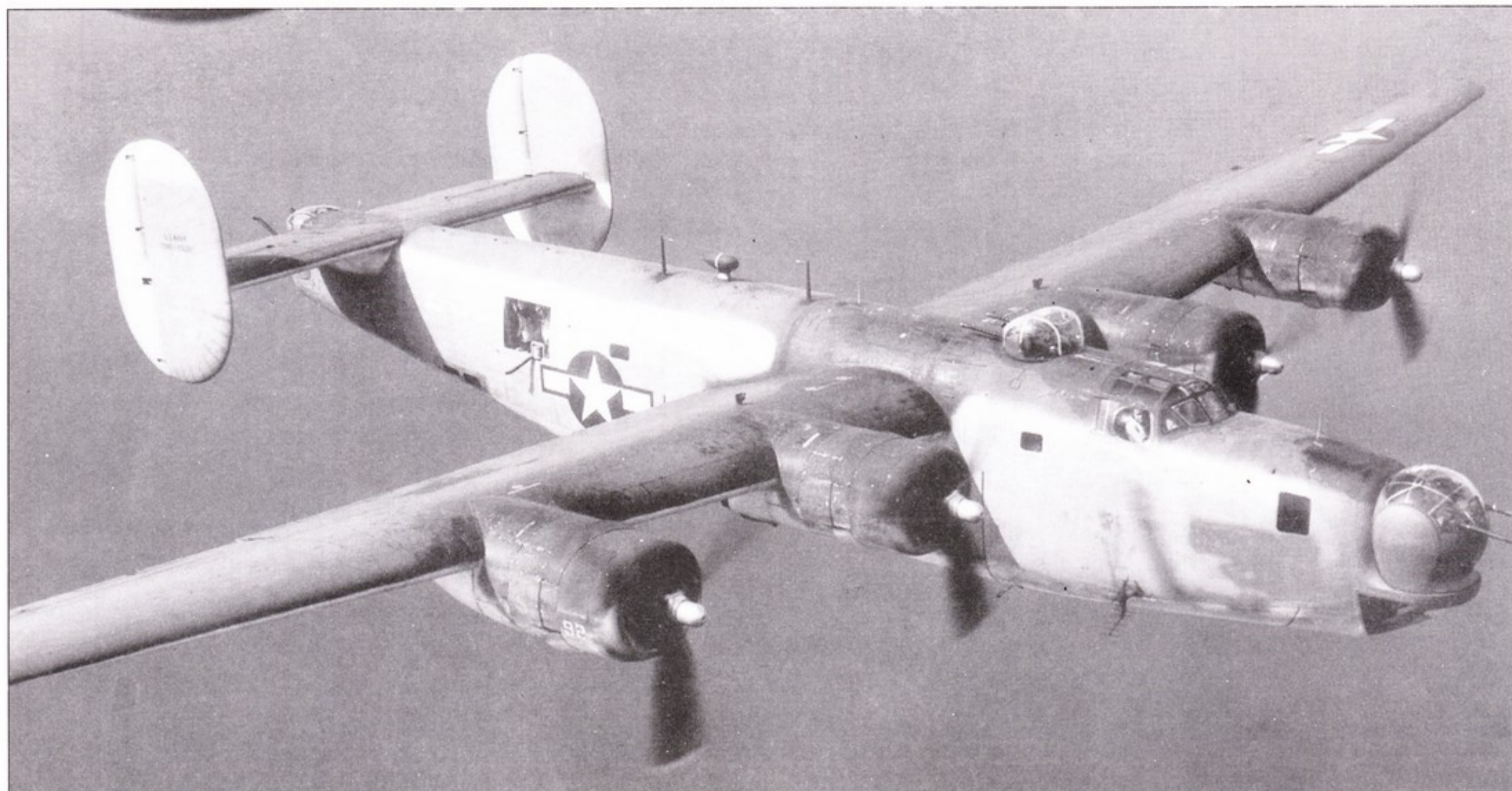
«Консолидейт» PB4Y-1 «Либерейтор» (Z92, ВuNo 65318) в патрульном полете над Тихим океаном, 1945 год. Это самолет поздней серии с турелью Эрко. Самолет несет следы интенсивной эксплуатации и многочисленных перекрасок. Код самолета Z92 на фюзеляже оранжево-желтый. Морская авиация использовала самолеты этого типа для дальних противолодочных рейдов.
