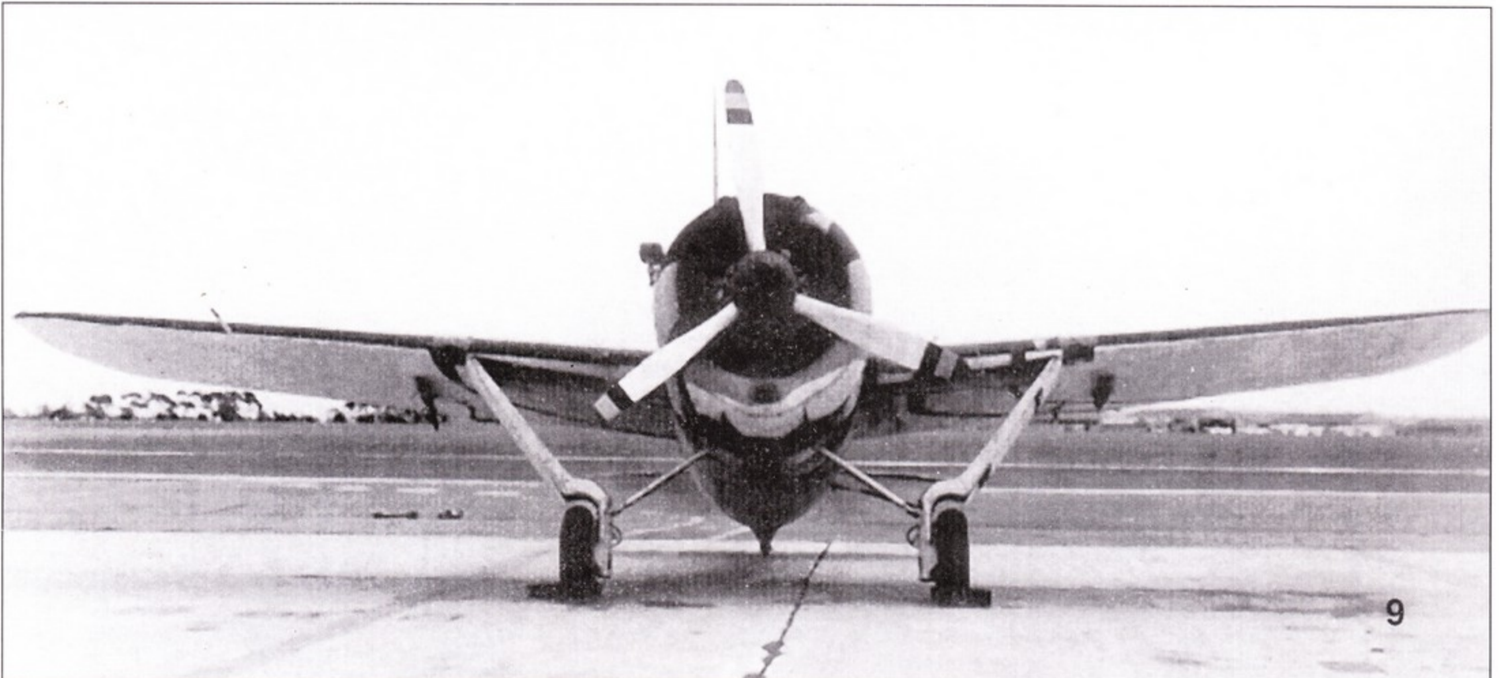
Фотография спереди все той же машины. С конца 1940 года винты в морской авиации стали краситься черным. Эскадрилья VF-3 базировалась на борту авианосца «Саратога» и была первой перевооружена на «Буффало» (в июне 1940 года).
