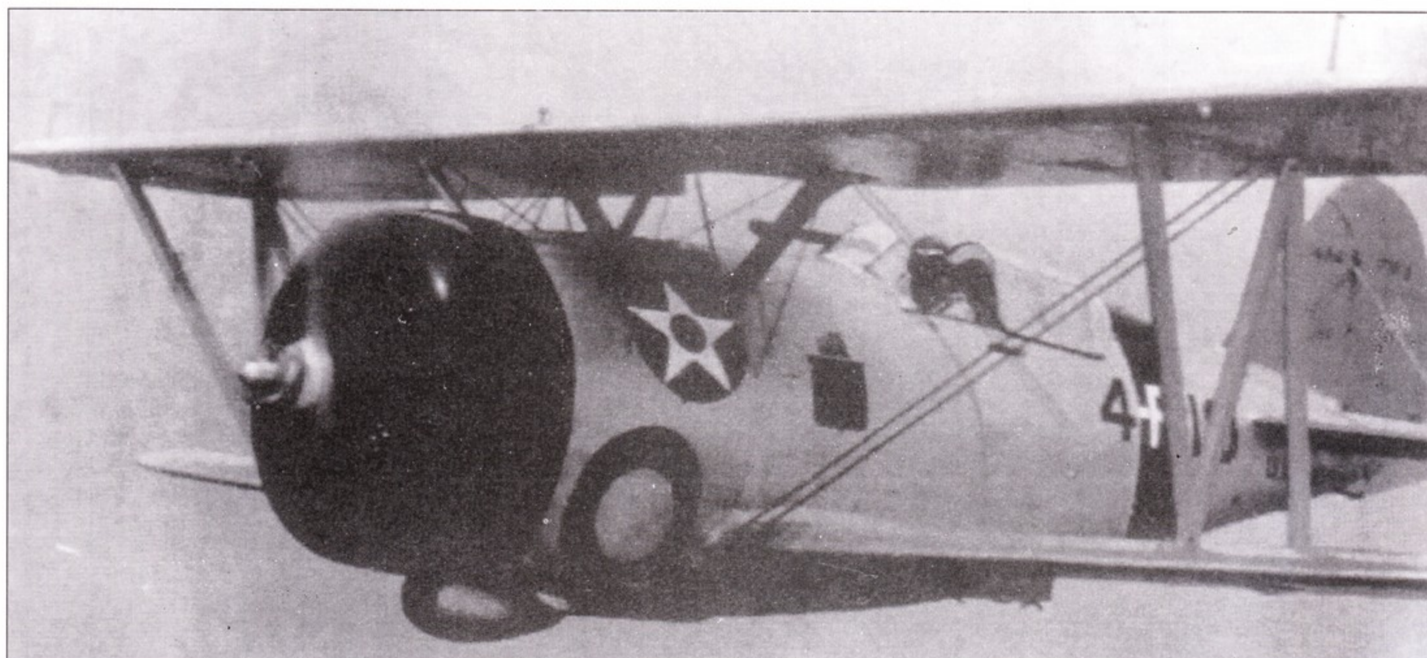
F3F-3 (4-F-10, BuNo 1454) из состава VF-4 выполняет патрульный вылет в рамках «Нейтрального Патруля» с авианосца «Рейнджер» в 1940 году. Это истребитель командира 4-го звена эскадрильи, что видно по черному двигателю и фюзеляжной полосе с белой окантовкой. Эмблема эскадрильи нанесена на передней части фюзеляжа рядом с опознавательным знаком. Фирма «Грумман» построила 27 F3F-3 – последние американские истребители – бипланы – поставлены флоту с конца 1938 года по начало 1939 года. Другая разработка фирмы – истребитель F4F-3 заменил F3F на палубах американских авианосцев с начала 1941 года.
