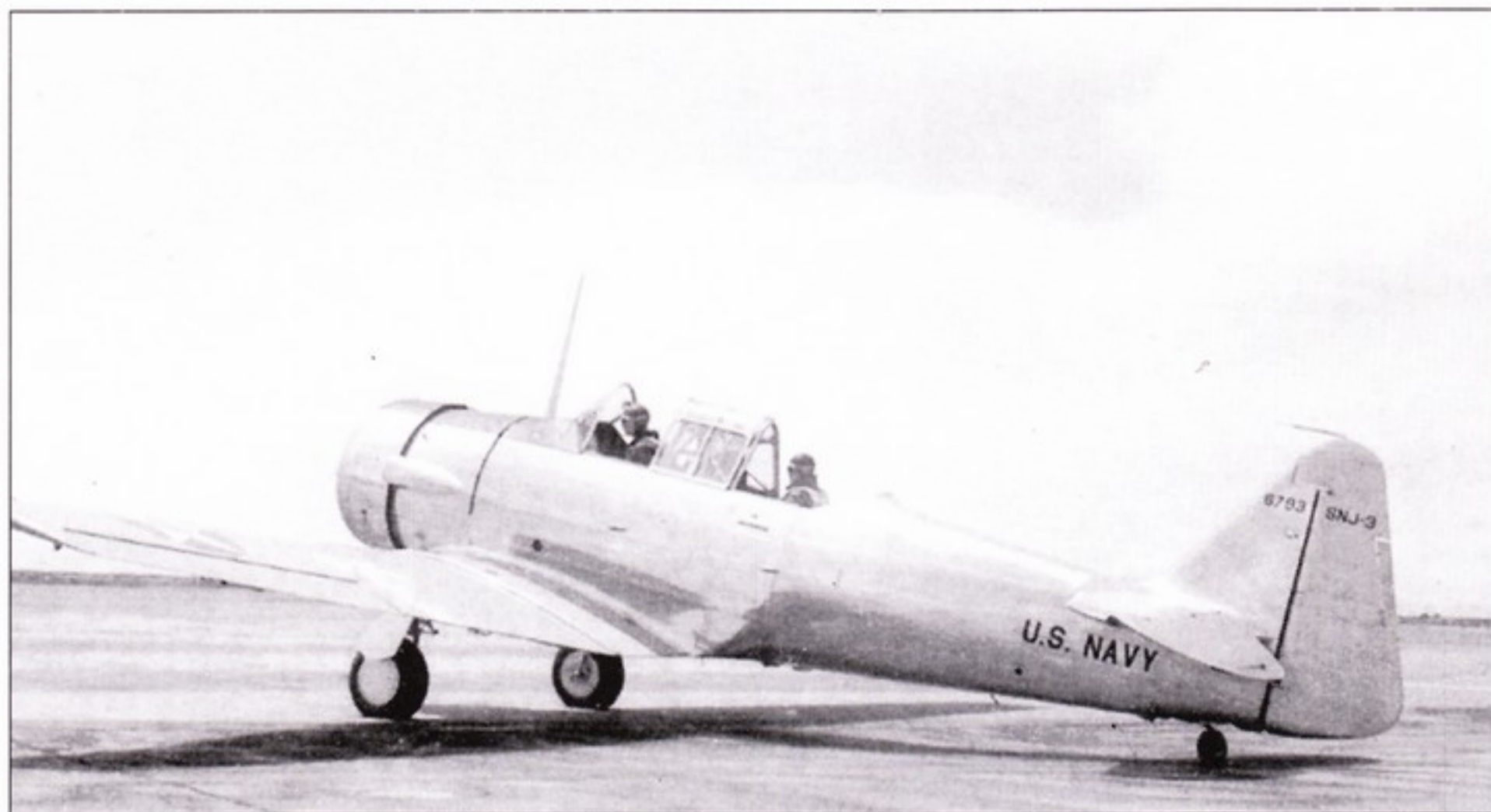
Новенький «Норт Америкен» SNJ-3 (BuNo 6793) блестит на солнце натуральным металлом. Передняя часть от фонаря (антибликовая полоса) покрашена средне-зеленым (NS Medium Green (FS34092). Верхние поверхности покрашены оранжево-желтым. SNJ-3 соответствует армейским AT-6A «Тексан».
