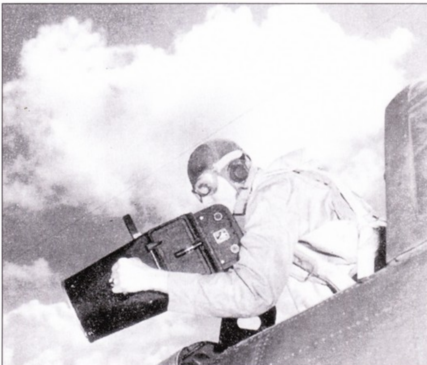
Фотограф VB-5 Вильям Рой (Mate 3/c William G. Roy) устанавливает 50.8-см фотокамеру Fairchild F-1 в задней кабине своего SBD на борту авианосца «Йорктаун» (CV-5), апрель 1942 года. Он одет в коричневый летный шлем, легкий летный комбинезон и оранжево-желтый спасательный жилет.
