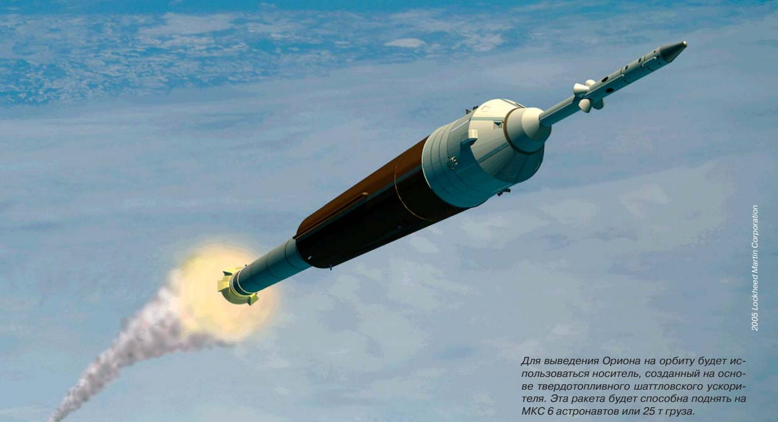
Для выведения Ориона на орбиту будет использоваться носитель, созданный на основе твердотопливного шаттловского ускорителя. Эта ракета будет способна поднять на МКС 6 астронавтов или 25 т груза.
