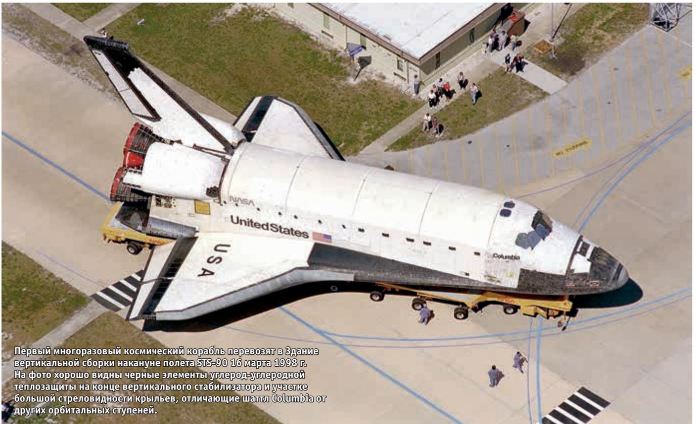
Первый многоразовый космический корабль перевозят в Здание вертикальной сборки накануне полета STS-90 16 марта 1998 г. На фото хорошо видны черные элементы углерод-углеродной теплозащиты на конце вертикального стабилизатора и участке большой стреловидности крыльев, отличающие шаттл Columbia от других орбитальных ступеней.
