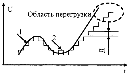
Рис. 9.17. Линейная дельта-модуляция: аналоговый сигнал (кривая 1) и сигнал квантователя линейной ДМ (кривая 2)
