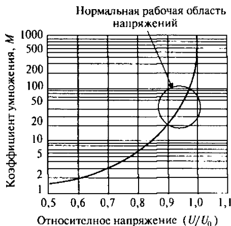
Рис. 3.44. Зависимость коэффициента умножения лавинного фотодиода от рабочего напряжения обратного смещения
