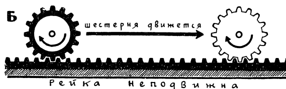
Шестерня с рейкой Рис. 208.
