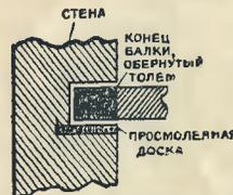
Заделка конца балки в стене.
