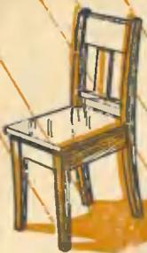
Лучи солнца отбрасывают тень предмета на поверхность пола (рис. 1). Эту тень можно назвать проекцией предмета, лучи солнца — проектирующими лучами, а плоскость пола — плоскостью проекции. Но «теневая» проекция — это еще не чертёж.
