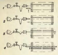
(рис. III) и. достигнув крайнего противоположного (правого) положения, освобождает конец уточной нити. Захватчик опускается на конвейер (рис. IV), расположенный под нитями основы, и доставляется им на левую сторону станка. Цикл повторяется. Обычно применяют 16 таких захватчиков, эни один за другим прокладывают уточную нить -пролетают с нею с левой стороны станка на правую и возвращаются транспортером обратно.
