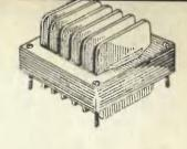
вующим цепям схемы усилителя. Установленные на шасси трансформаторы закрываются снизу и сверху кожухами из мягкого железа для устранения наводок на цепи
