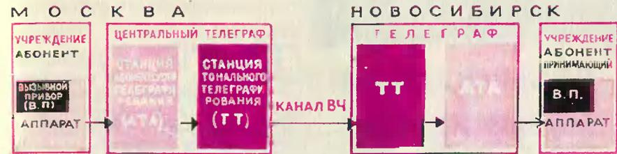
Блок-схема абонентского телеграфирования.
