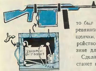
Вспомните, как работает звонок? Нажали на кнопку, цепь замкнулась, и ударник начал трель. Если бы он ударял по металлической пластинке, то был бы слышен звон, а так как он бьет по деревянному резонатору, раздаются дребезжащие щелчки, напоминающие пулеметную очередь. Устройство пулемета понятно из рисунка — в магазине для патронов закреплена электробатарейка.
