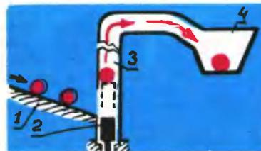
2. Шарик, скатывающийся по наклонному лотку, должны попасть в бункер-накопитель. А ход поршня в гидроцилиндре значительно меньше высоты расположения бункера над лотком. Каким устройством нужно дополнить систему, чтобы направить шарик в бункер?
