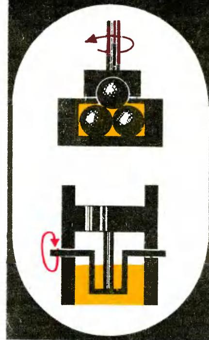
По износу шаров в машине трения (рис. сверху) определяются смазывающие свойства присадки, а на другой машине (рис. внизу) исследуются антиокислительные свойства.
