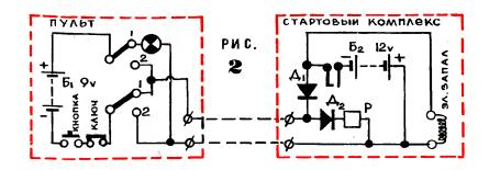
накалиться. Диод  $\mathbf{A}_2$  не пропускает ток через реле  $\mathbf{P}_2$  поэтому батарея  $\mathbf{B}_2$  остается отключенной.
