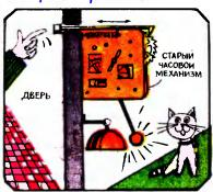
БУДИЛЬНИК ДЛЯ дверей «Вот уже цельй год у меня исправно работает механический звонок, который я переделал из будильника», — пишет Слава Рекун из Житомира. И действительно, конструкция звонка очень проста, требуется даже не весь будильник, а только механизм
