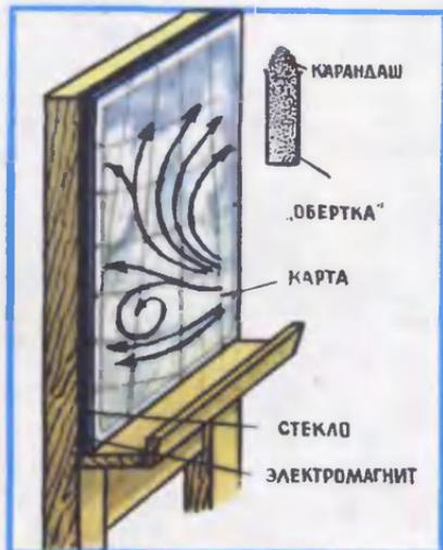
лагаю очень удобную конструкцию магнитной карты. На массивном основании с лотком устанавливаются прозрачное стекло и намагниченный кусок железной пластины. Между ними вкладывается географическая карта. Для того чтобы рисовать по стеклу, я изготовил особый карандаш, у которого вместо грифеля используется слегка прессованный железный порошок», — пишет Сергей Издебский из Алма-Аты.
