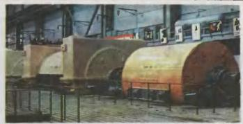
На снимке — общий вид зала, где испытываются все мощные турбогенераторы.
