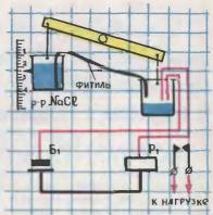
сосуде достигнет контактов, цепь электромагнитного реле замкнется и включит нагрузку. Скорость заполнения сосуда, а значит, и время срабатывания реле зависят от положения уровня раствора в верхнем сосуде.
