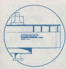
Слева: Гидрогенератор для Братской ГЭС кВт и статор диаметром 19,5 м для Красноярской ГЭС.
