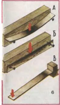
расстояние крайних волокон от нейтрали и, следовательно, использовали прочностные возможности материала эффективнее.
