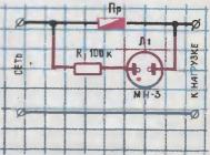
**ИНДИКАТОР** НАПРЯЖЕНИЯ. Чтобы точно знать, отключено ли электропроводке напряжение или сгорели пробки, нужно параллельно электрическому предохранителю включать неоновую лампочку с ограничительным сопротивлением. Если загорается лампочка, значит, перегорел предохранитель. А вот если нет напряжения и не горит индикатор, значит, повреждение на подстанне нужно проверять 14 пробку.
