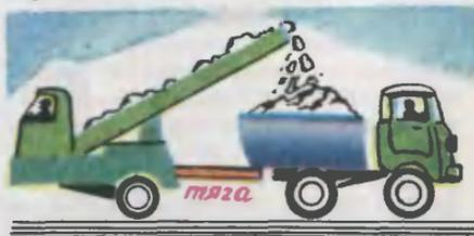
ся, простая деталь, а смотрите, как облегчает она работу водителю самосвала, ведь в этом случае ему не нужно внимательно следить за скоростью снегоборщика. Главное для него — плавно подъехать, зацепиться и установить рычаг сцепления в нейтральное положение.
