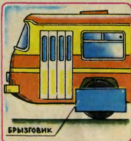
шанбе. — Их можно сделать из брезента или прорезиненной ткани. Брызговики должны прикрывать нижнюю часть колес. У задних колес они крепятся прямо к корпусу, а у передних с помощью кронштейнов — чтобы не мешать колесам при повороте».
