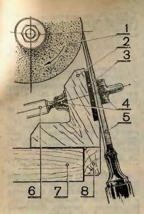
Приспособление для заточки стамесок: 1 — абразивный кажень; 2 — деревянная подставка; 3 — резиновая прокладка; 4 — струбцина; 5 — стамеска; 6 — винт струбцины; 7 — верстак; 8—бортик подставки.
