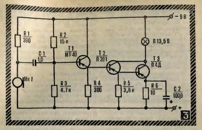
мощный полупроводниковый прибор, например из серии П4 или П215-П217. Важно, чтобы его коэффициент усиления был не менее 20.
