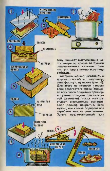
формовки пуансон вкладывают в емкость (рис. 7), предварительно наполненную цементным раствором (для быстрого схватывания в него добавляют немного силикатного клея). Когда цемент схватится, пуансон вынимают, удаляют воск, и матрицу оставляют на некоторое время для окончательного затвердевания.
