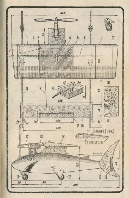
Нервюры — их шесть — вырезаны из фанеры толщиной 1 мм. Для облегчения в них вырезаны отверстия, а также сделаны прорези под лонжероны. Каркас крыла обклеен микалентной бумагой. Установка готового крыла на фюзеляж не представляет большого труда — так считают авторы модели. Главное — укрепить его без перекоса.
