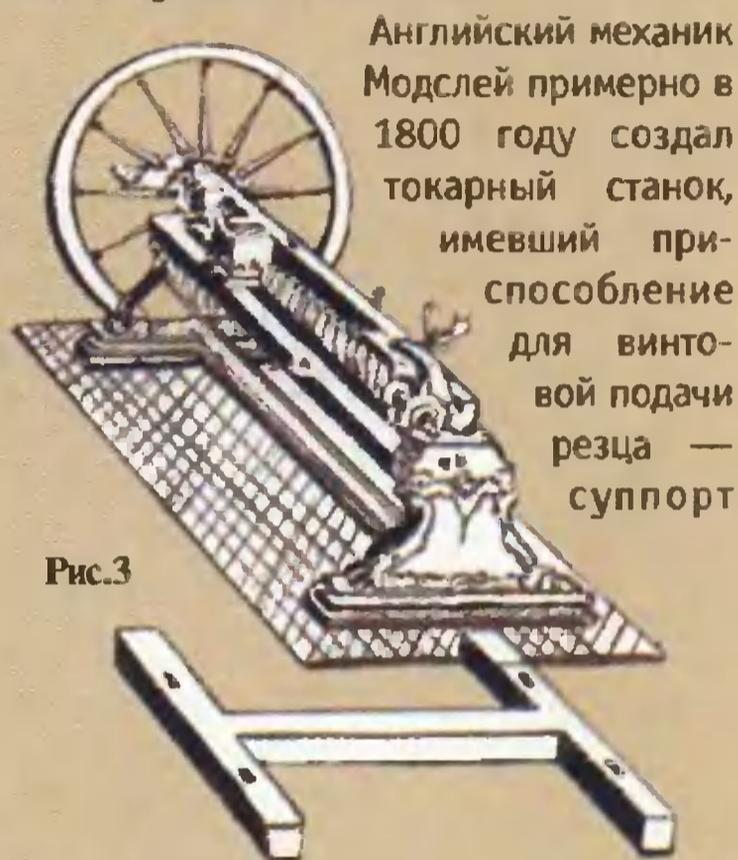
Английский механик Модслей примерно в 1800 году создал токарный станок, имевший приспособление для винтовой подачи резца — суппорт
