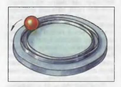
рожно установим медный шарик, диаметр которого примерно втрое больше ширины колеи. Как только он окажется на рельсах, сразу же станет катиться по ним, описывая круг за кругом. Остановленный и снова отпущенный, шарик опять будет двигаться. Кольцо должно лежать горизонтально.
