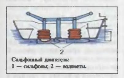
клапанами: один на входе, другой на выходе. При сжимании сильфона мембрана выталкивает порцию воды. Возникает гидрореактивный импульс, который и толкает катер.
