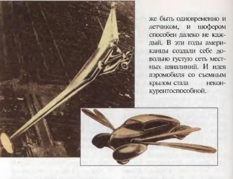
органы управления, расположенные на крыле. Они соединялись тросами с рычагом самолетного типа, который устанавливался в кабине. Крепление крыла, проводка тросов и установка рычага — в этом и заключалась доработка автомобиля. Дело на первый взгляд простое, но на поверку оказавшееся очень хлопотным.
