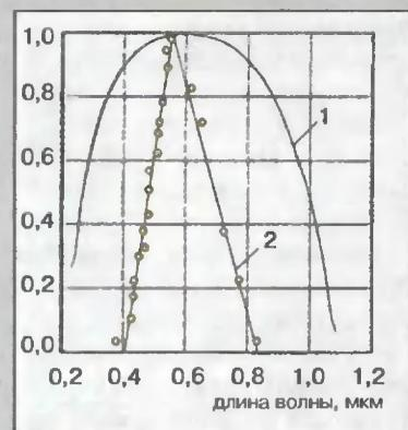
Рис. 2. 1 — фоточувствительность солнечного элемента; 2 — относительная светоотдача калильной лампы.
