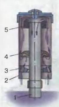
стью воды, никакого препятствия для дыхания нет. Силой легких воздух легко втягивается в трубку. Но стоит погрузиться, как вступает в действие клапан — гибкая манжета. Под напором воды
