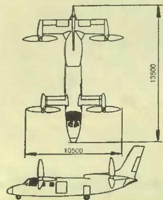
Весной 1964 года состоялся первый полет экспериментального самолета X-19. Машина имела четыре полноразмерных крыла, на концах которых расположены трехлопастные пластиковые винты, которые могут поворачиваться на угол до 90°. Благодаря такой геометрии стал возможен вертикальный взлет машины.
