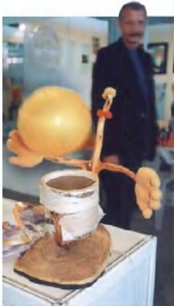
Шарик в воздухе поддерживают не забавные ладошки, приводимые в движение электромотором, а воздушная струя.
