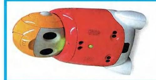
прототип Робота-дегу-СТАТОРА построен в Японии. Он различает продукты с помощью инфракрасного спектрометра, расположенного на выдвижном манипу-
