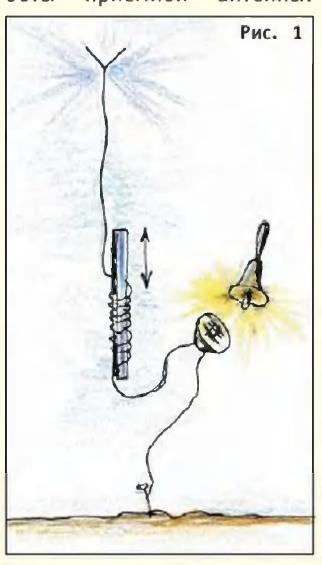
Под действием приходящих радиоволн в ней возникают токи, создающие вокруг антенны собственное поле. Оно действует в непосредственной близости от нее, на расстоянии менее длины волны. Поэтому его называют ближним полем. Если антенна настроена в резонанс с частотой приходящих радиоволн, то ближнее поле как бы увеличивается в размерах, распухает и окутывает антенну. Антенна как бы многократно увеличивается в размеpax.
