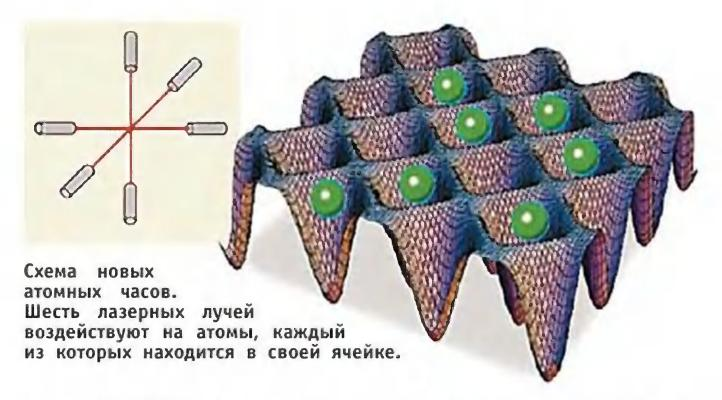
ния. И тогда измеряется сигнал каждого из атомов. Затем все показания суммируются. Таким образом сигнал не только усиливается, но и исключаются ошибки случайных отклонений; ведь в итоге за истину принимается среднее арифметическое многих значений.
