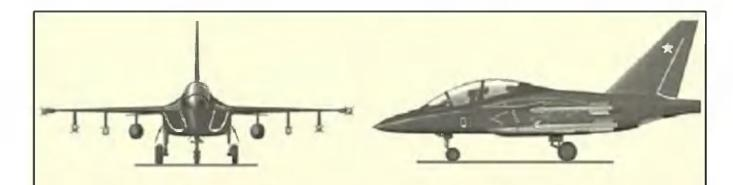
Як-130 — это двухместный двухдвигательный среднеплан с трехстоечным шасси. Его аэродинамическая компоновка, высокомеханизированное крыло с развитыми наплывами, цельноповоротный стабилизатор и расположение воздухозаборников позволяют выполнять маневры на больших углах атаки. Самолет может использовать для взлета и посадки короткие бетонные и даже грунтовые полосы.
