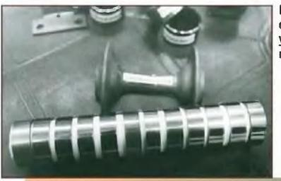
Все это сварено ударной волной. ударную волну. Она и заставляет заготовку деформироваться. Причем позади пули образуются пузыри, каверны, которые, схлопываясь, опять-таки порождают серию гидравлических ударов, «дожимающих» деталь. И все это опять-таки в считаные доли секунды.
