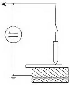
емкости, выпрямителя для их зарядки и ключа. На первых порах Сергей использовал для сварки обычную кнопку звонка. Но контакты ее искрили и быстро выходили из строя. Тогда он стал подключать конденсаторы через тиристор, а кнопку поставил в цепь его управления. Ток через контакты уменьшился в сотни раз, кнопка стала служить долго (см. рис.).
