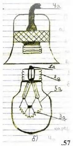
те его. Вы увидите, что из колбы лампы выходят два провода. Один припаян к цоколю, а другой — к контакту в его центре. Когда же лампа ставится в патрон, то один сетевой провод через дугообразный контакт соединяется с цоколем, а другой через контакт-пружинку соединяется с центральным контактом лампы. Благодаря этому ток проходит через лампу, и она работает.
