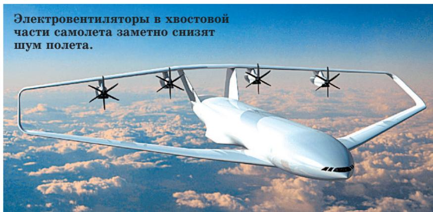
Электровентиляторы в хвостовой части самолета заметно снизят шум полета.
