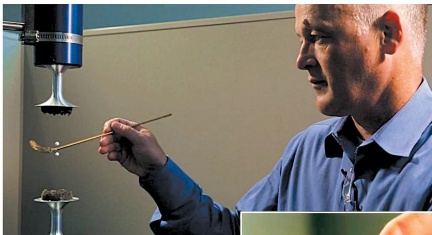
С помощью ультразвуковых волн можно удерживать и даже передвигать в воздухе небольшие предметы. На фото показана левитация над поверхностью отражателя шарика из полистирола и капля воды (справа).
