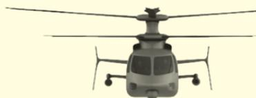
Sikorsky S-97 Raider (Сикорский S-97 «Налетчик») — разведывательный вертолет американской компании Sikorsky Aircraft, построенный по соосной схеме с толкающим винтом в хвостовой части. Разработан на базе экспериментального вертолета Х2. Первый полет S-97 состоялся 22 мая 2015 года в штате Флорида, США. Максимальная скорость до 407 км/ч.
