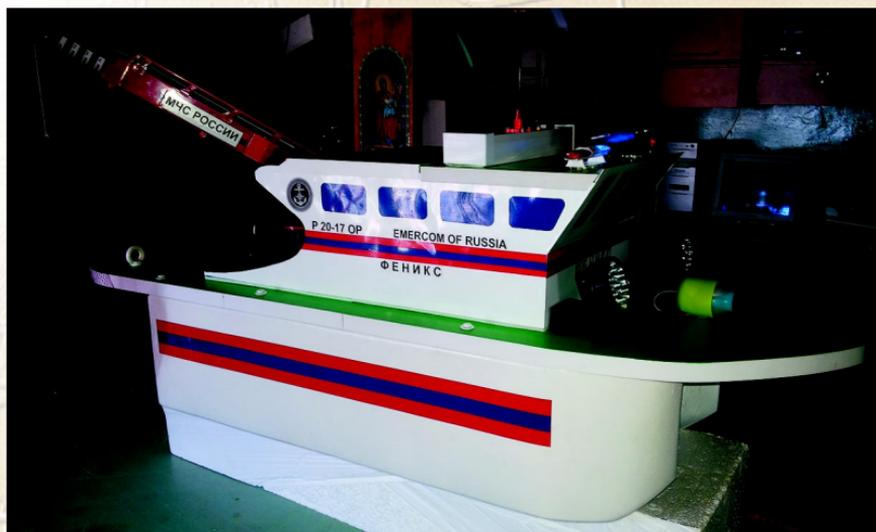
10,2 кг, вес одного аккумулятора — 1,8 кг; максимальная грузоподъемность катера — до 6 кг; максимальная скорость — до 20 км/ч.
