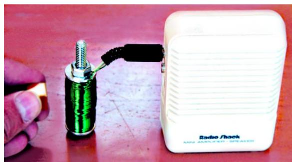
Так выглядит установка в готовом виде, вместе с катушкой, усилителем и динамиком. В пальцах экспериментатора зажат небольшой, но сильный магнит, которым он манипулирует.
