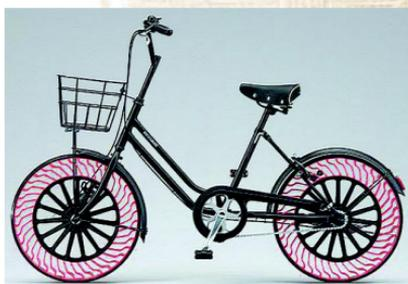
Bridgestone собирается наладить выпуск безвоздушных шин Air Free для велосипедов уже в 2019 году. Гибкие спицы, которые служат демпфирующим материалом в такой шине, изготовлены из специального термопластичного каучука. Он является полностью перерабатываемым материалом, пригодным к повторному использованию.
