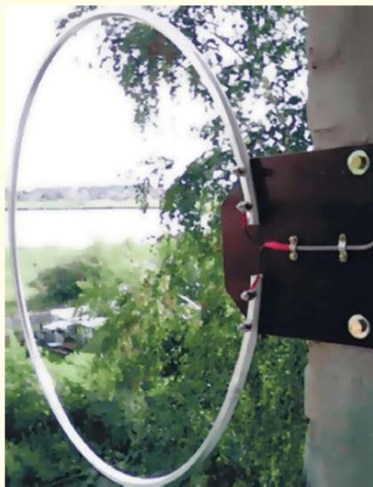
Рис. 11. Рамочная КВ-антенна.
